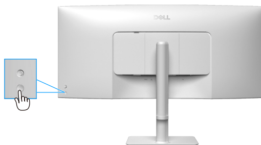
Figure 30. Allumer le moniteur
