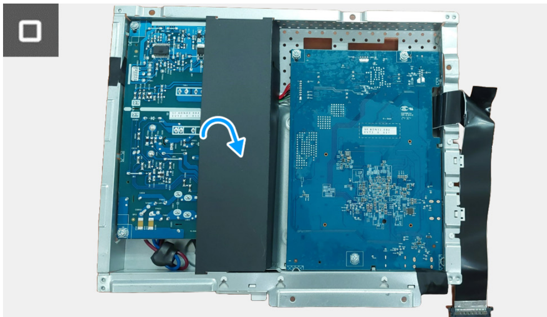
Rysunek 22. Montaż płytki interfejsu
