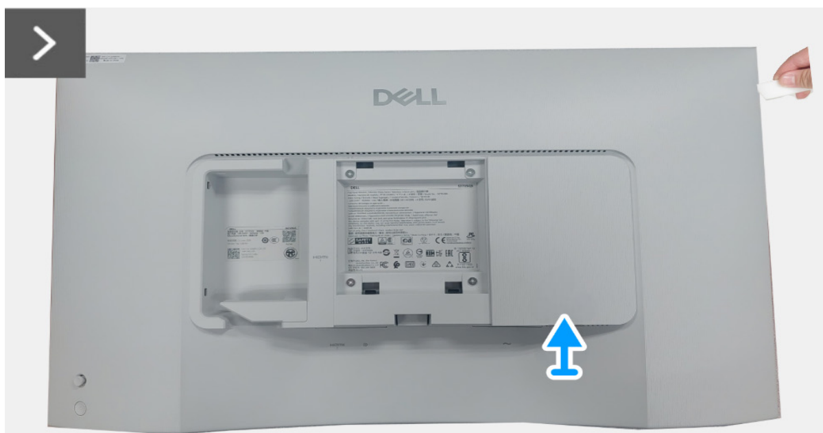
Rysunek 11. Demontaż tylnej pokrywy
