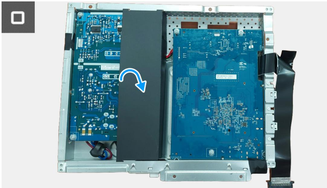
**Figura 14.** Instalar a placa de interface
