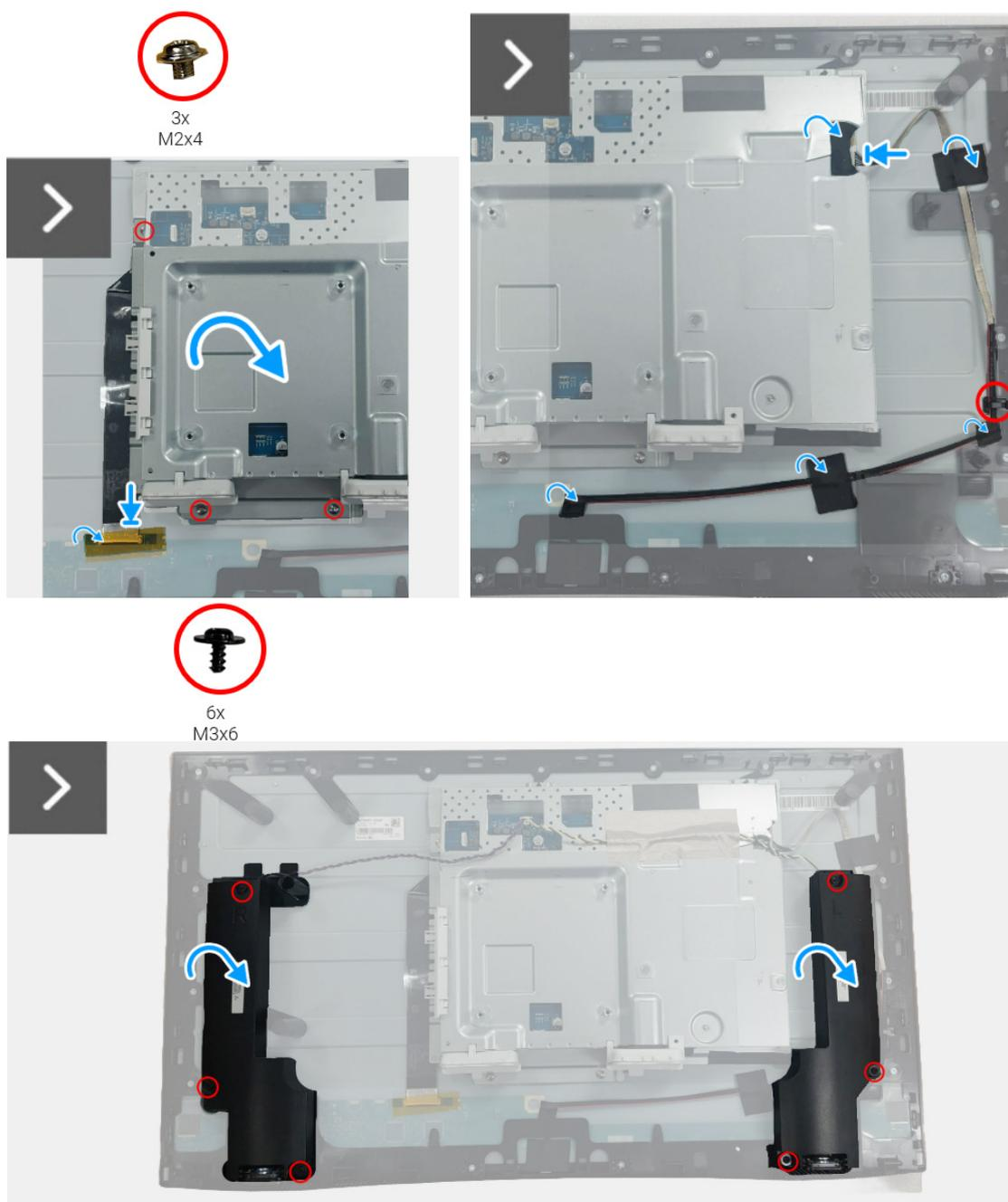
Figura 17. Instalar a placa de interface
