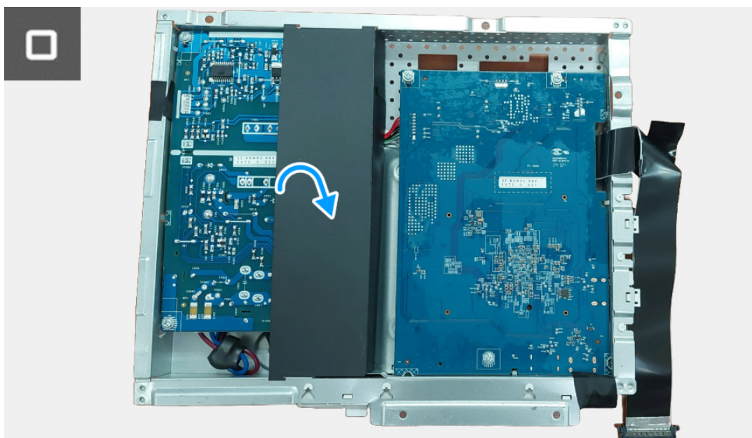
Immagine 14. Installazione della scheda interfaccia
