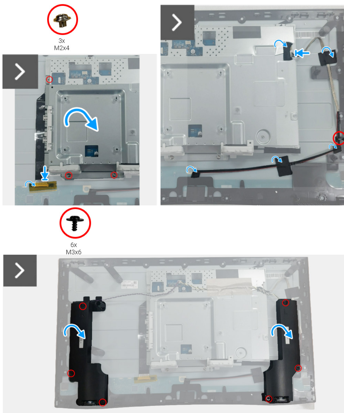
Immagine 9. Installazione del gruppo scheda interfaccia
