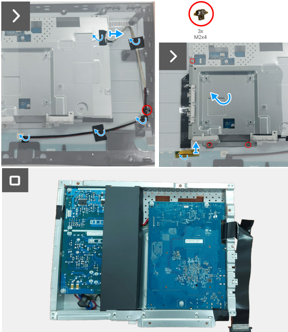
Immagine 8. Rimozione del gruppo scheda interfaccia
