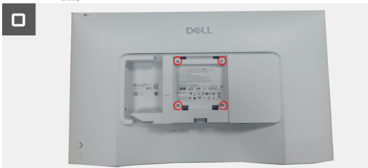
Obrázek 6. Instalace zadního krytu
