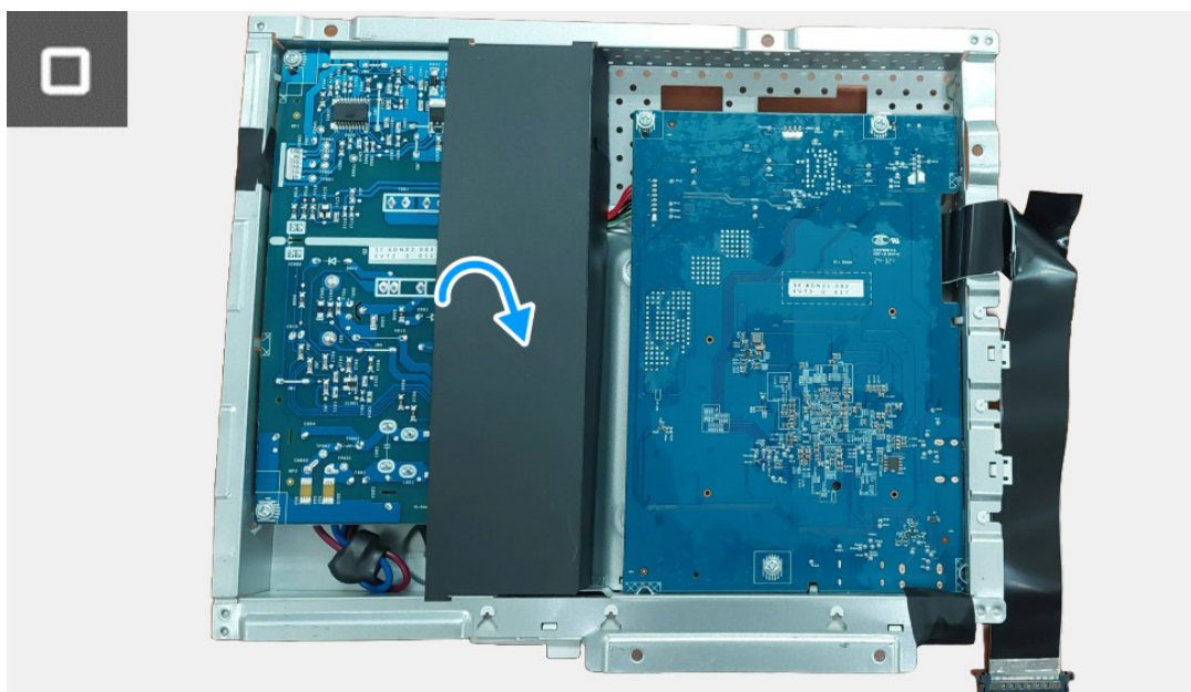
Obrázek 14. Instalace desky rozhraní
