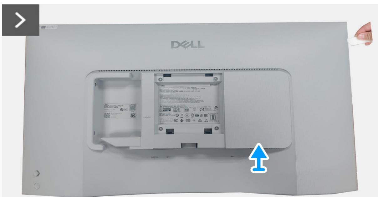
Figure 11. Retirer le couvercle arrière
