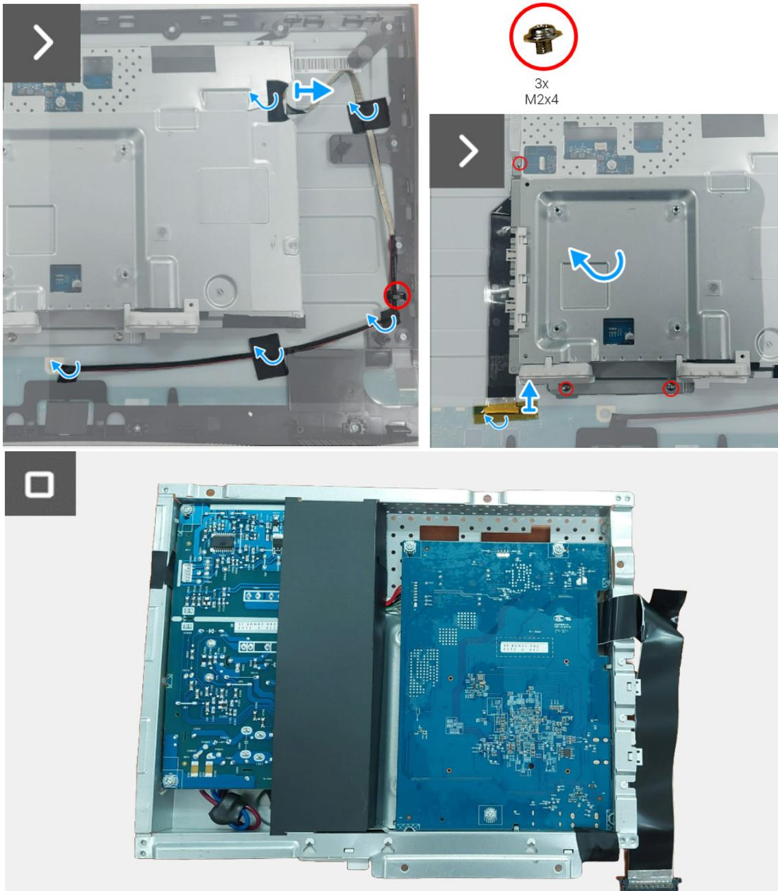
**Figure 16.** Retirer l'assemblage de la carte d'interface
