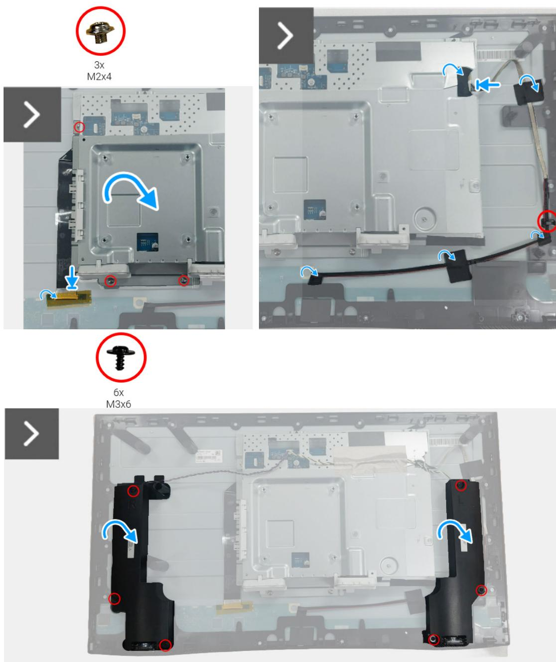
Figure 17. Installer l'assemblage de la carte d'interface
