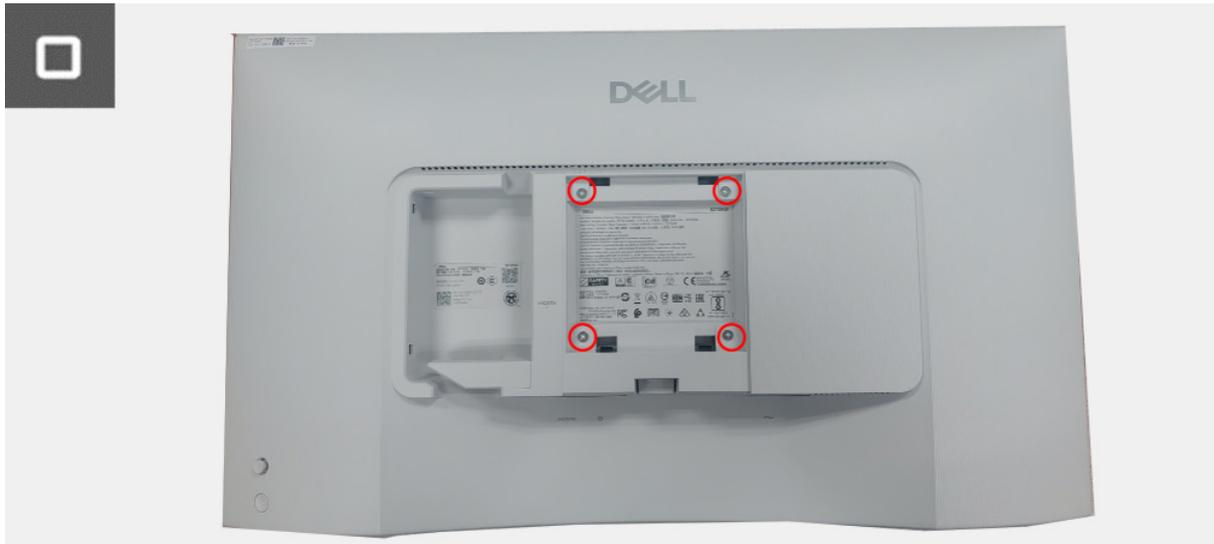
**Figure 14.** Installer le couvercle arrière
