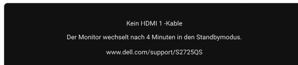
**Abbildung 69. Signalkabel getrennt Warmmeldung**
