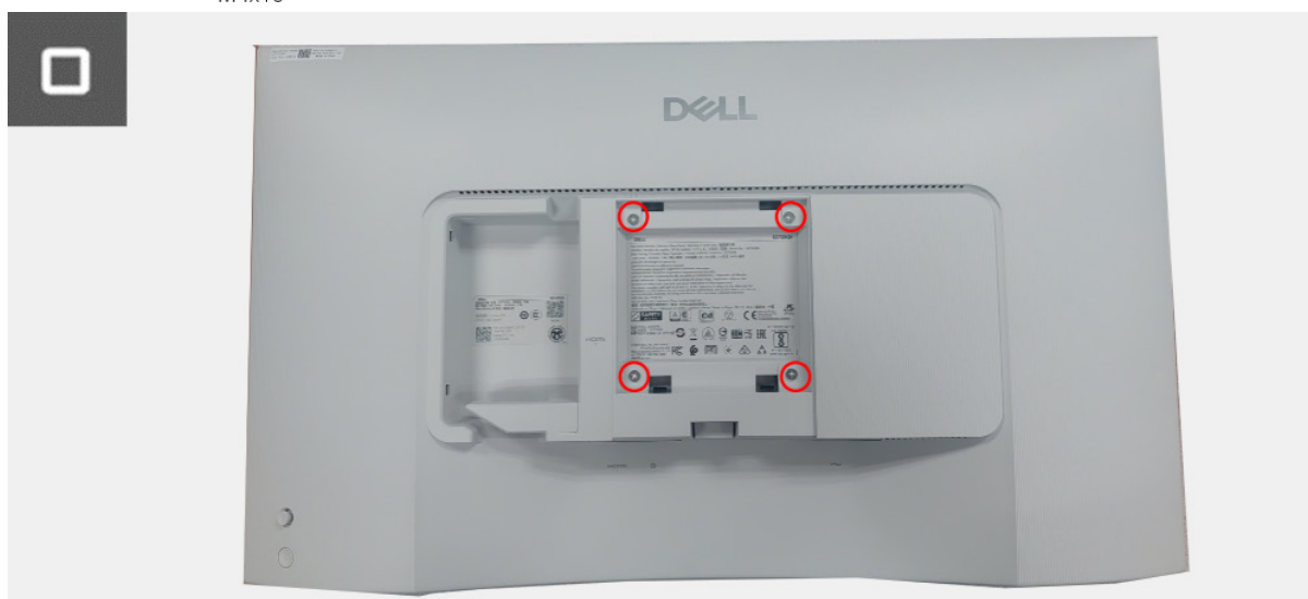
Figure 14. Installer le couvercle arrière
