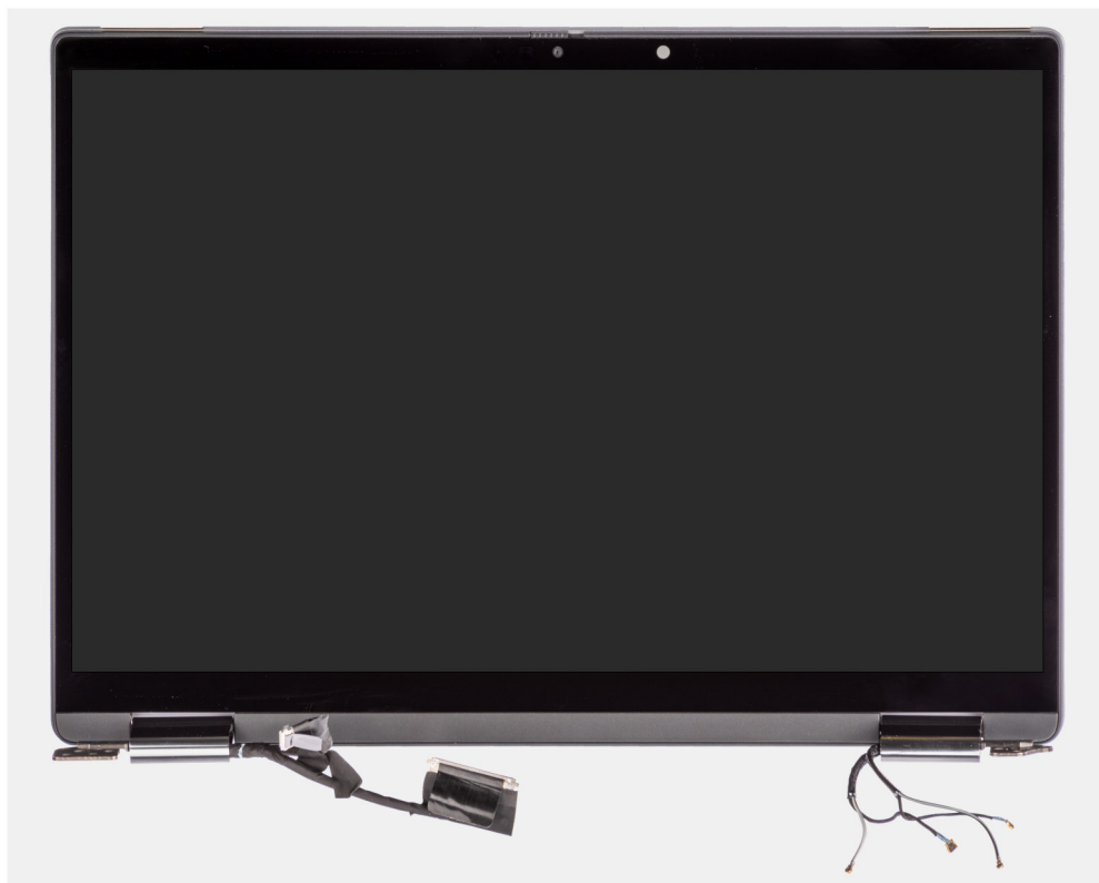
Figur 1. Bildskärmsenhet utan WWAN-antennkablar
