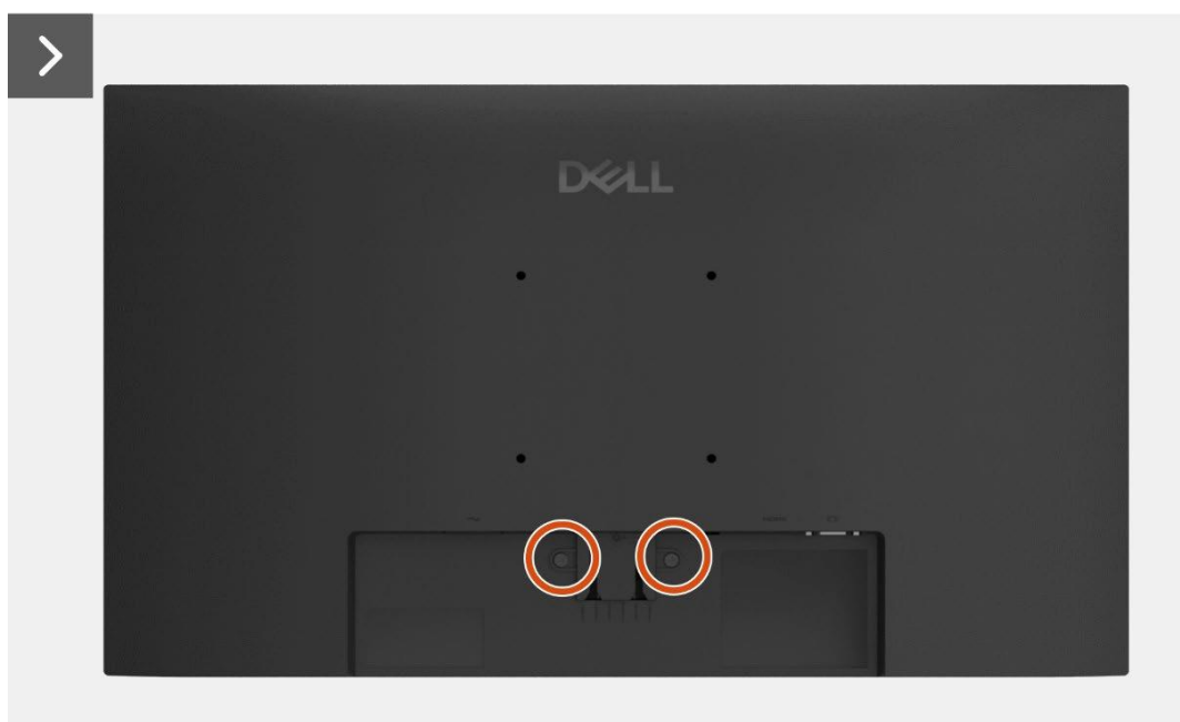
Rysunek 3. Zdejmowanie tylnej pokrywy
