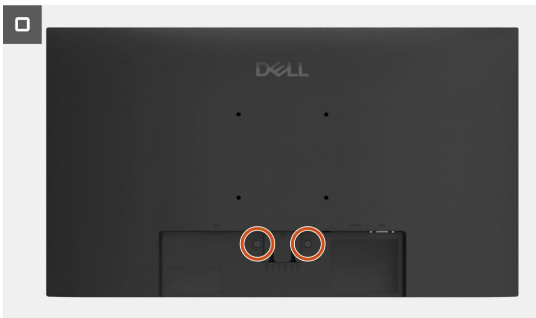
Rysunek 5. Instalowanie tylnej pokrywy
