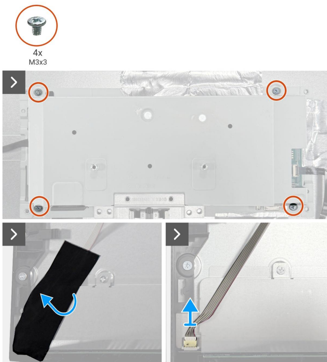
Rysunek 6. Demontaż zespołu obudowy
