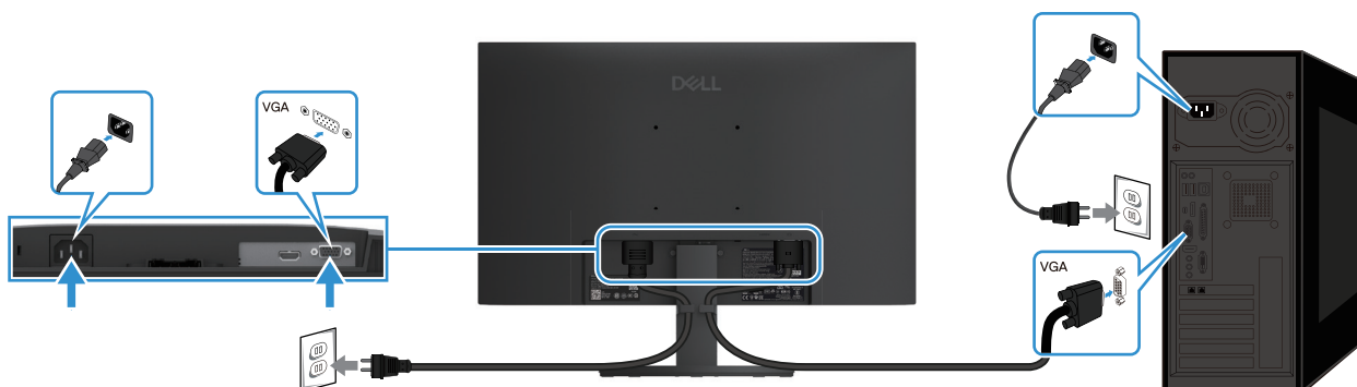
Rysunek 16. Podłączanie kabla VGA
