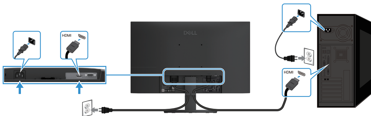
Rysunek 15. Podłączanie kabla HDMI
