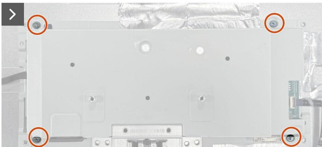
**Figura 8.** Instalar o conjunto da base inferior
