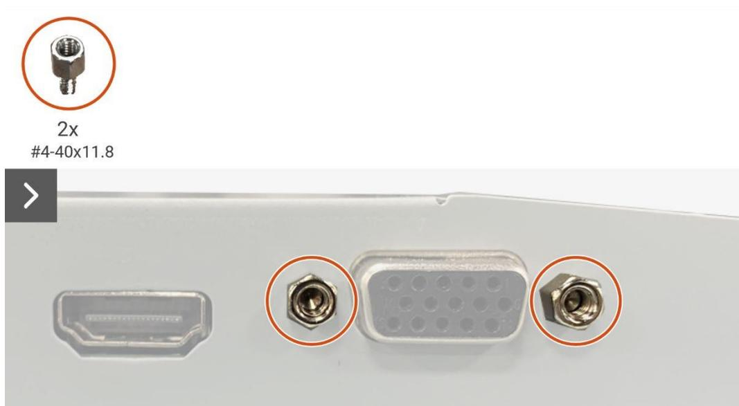
**Figura 12.** Remover a placa de interface
