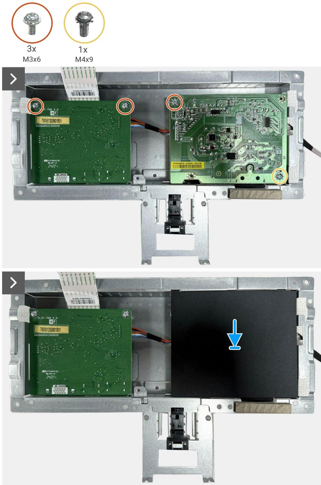
Figura 16. Instalar a placa de interface
