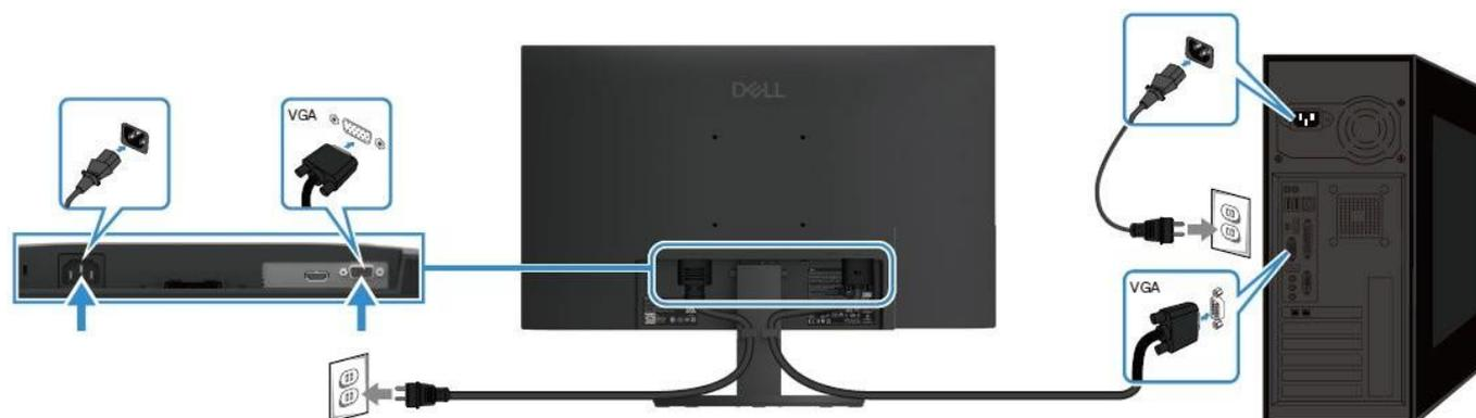
Figura 9. Collegamento del cavo VGA
