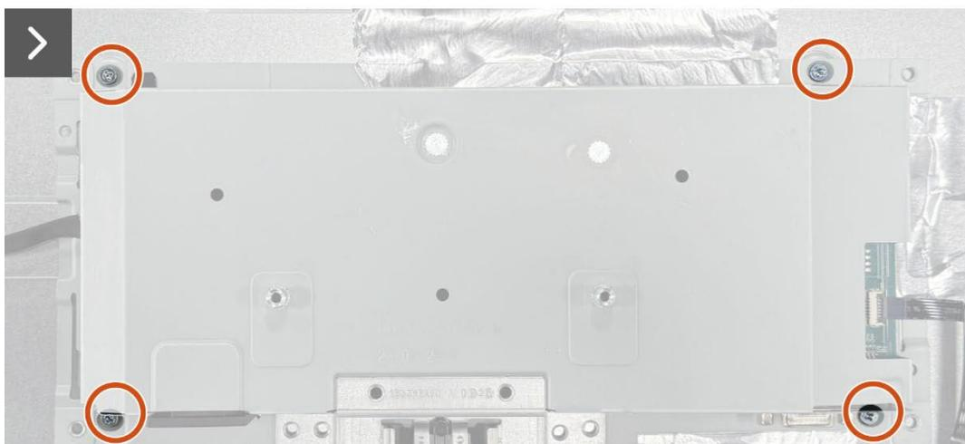
**Figura 17.** Installazione del gruppo telaio
