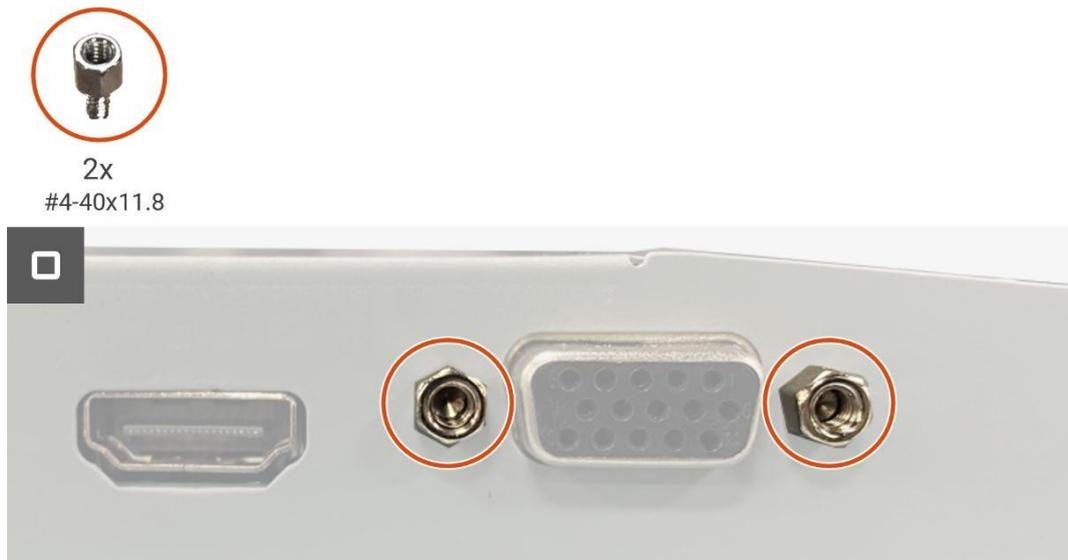
**Figura 26.** Installazione della scheda di interfaccia
