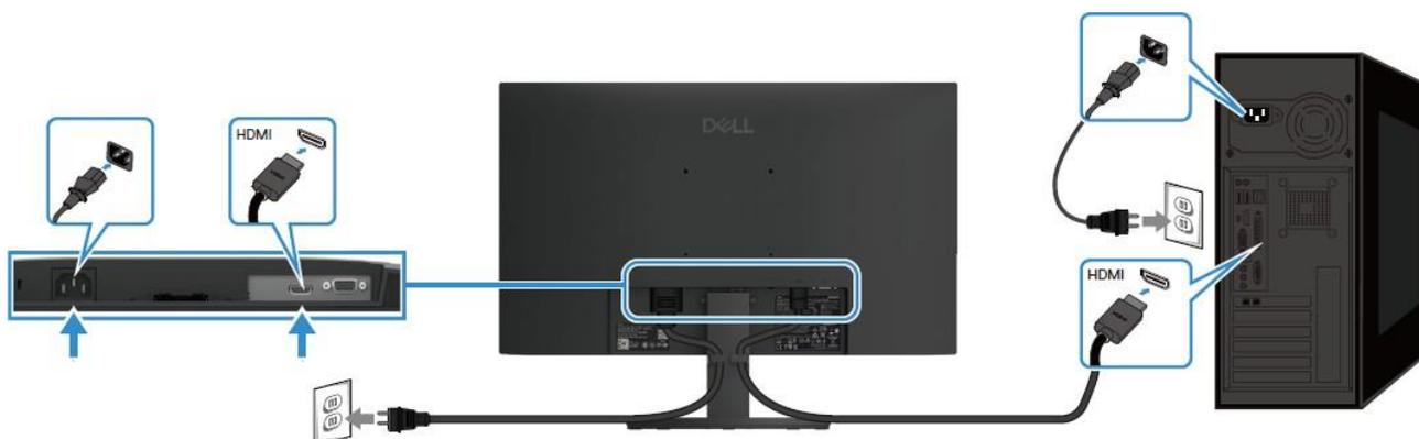
Figura 8. Collegamento del cavo HDMI
