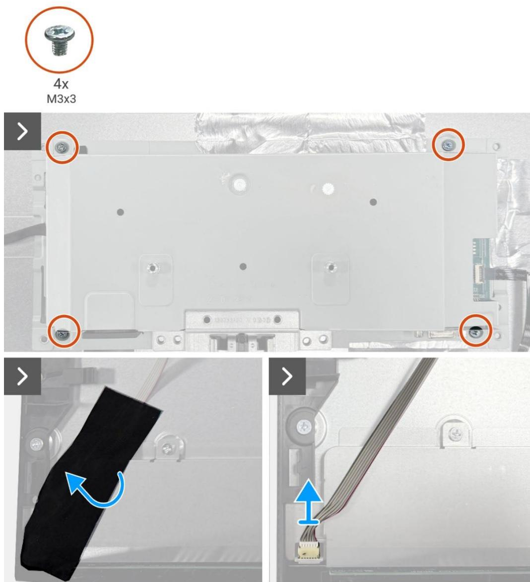
Figura 15. Rimozione del gruppo telaio
