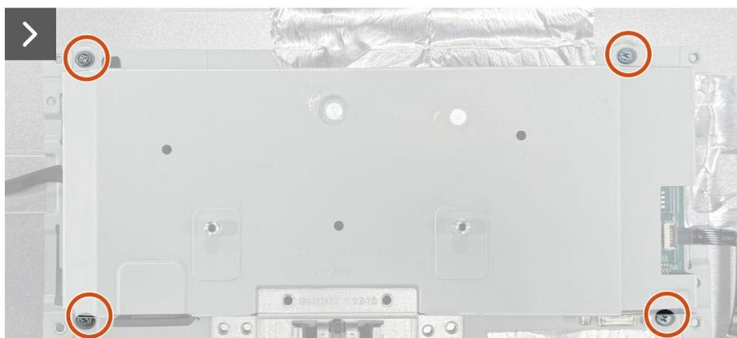
**Figura 8.** Installazione del gruppo telaio
