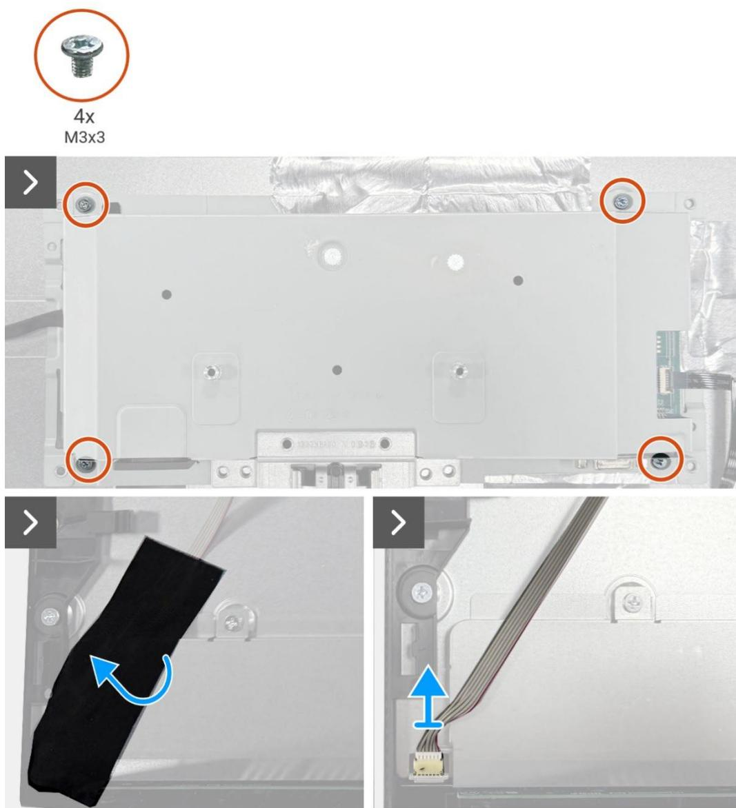
Figura 6. Rimozione del gruppo telaio
