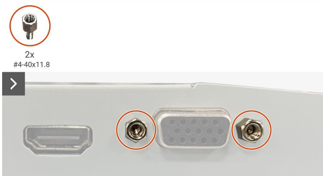
Obrázek 12. Odmontování desky rozhraní
