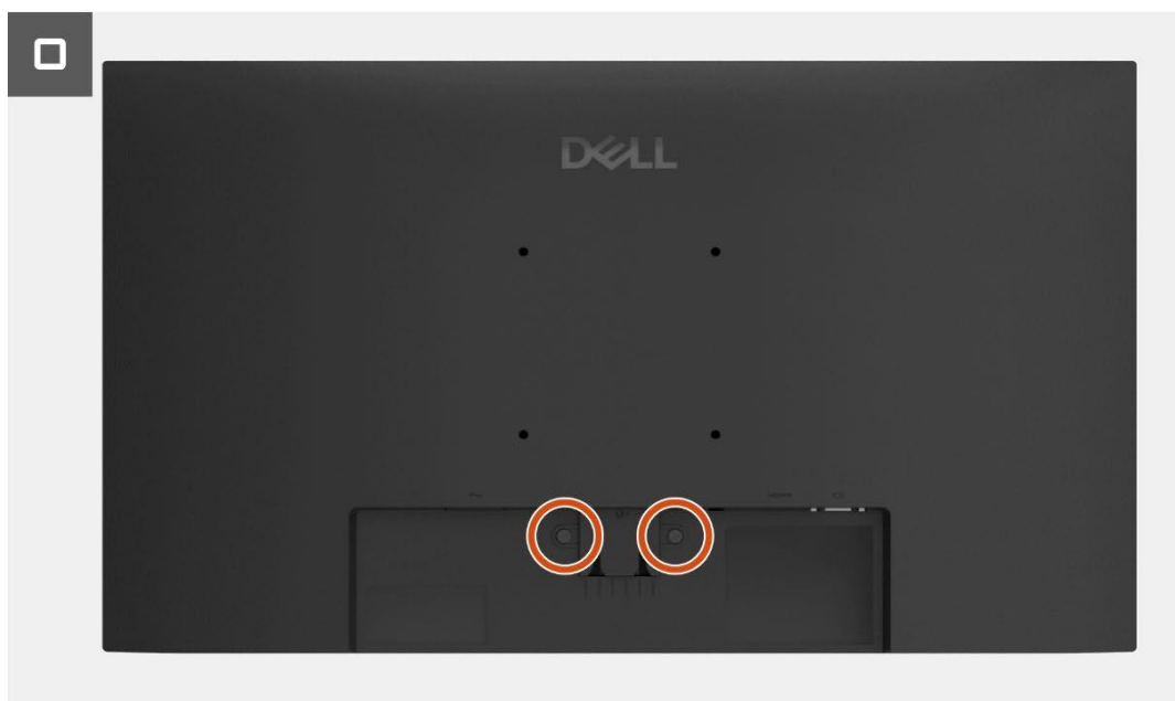
Obrázek 5. Instalace zadního krytu
