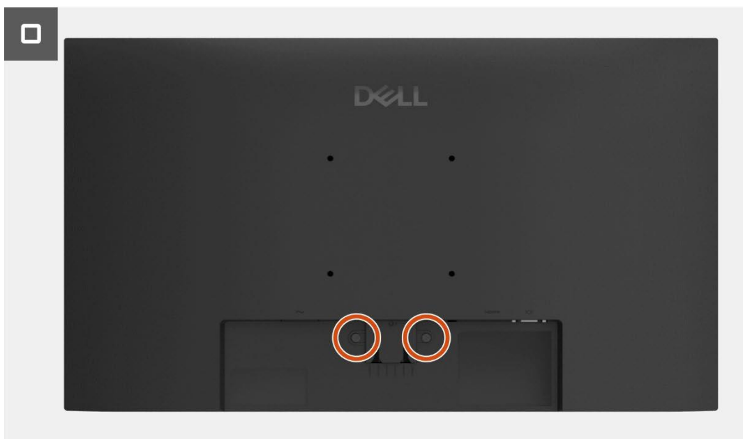
Imagen 14. Instalación de la cubierta trasera
