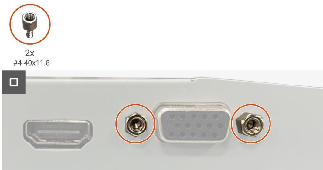
Imagen 26. Instalación de la placa de la interfaz
