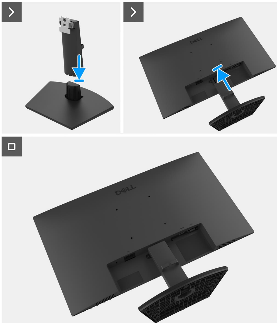
Imagen 11. Instalación del soporte
