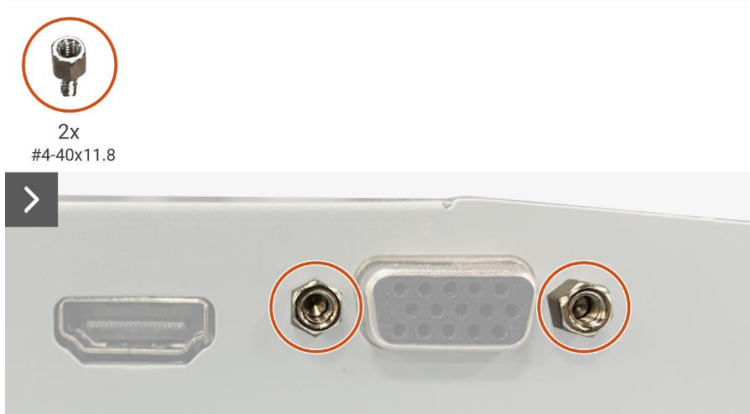
Imagen 21. Extracción de la placa de la interfaz
