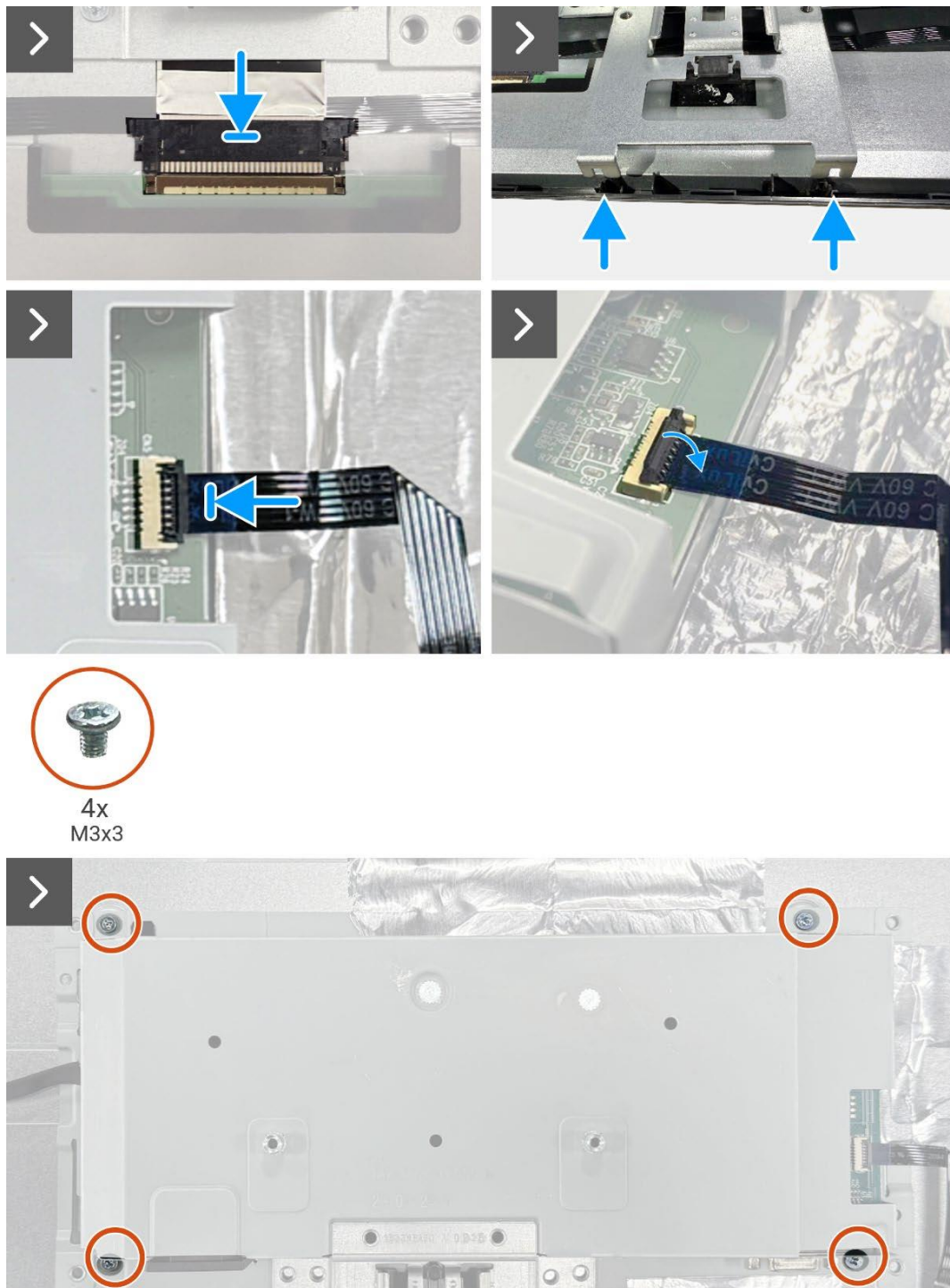
Imagen 17. Instalación del ensamblaje del chasis
