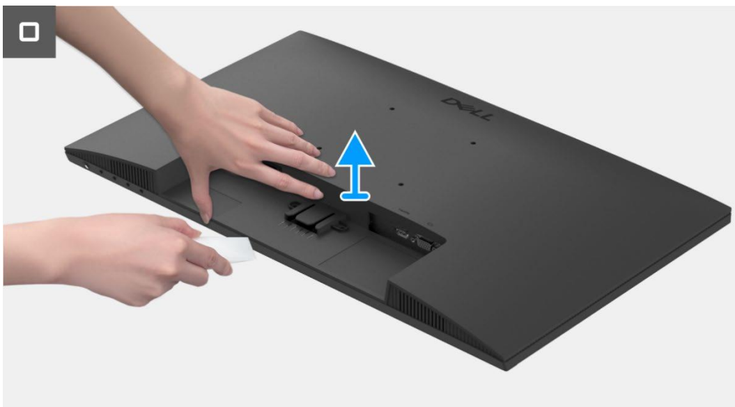
Imagen 4. Extracción de la cubierta trasera
