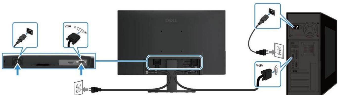
Figure 9. Connexion du câble VGA
