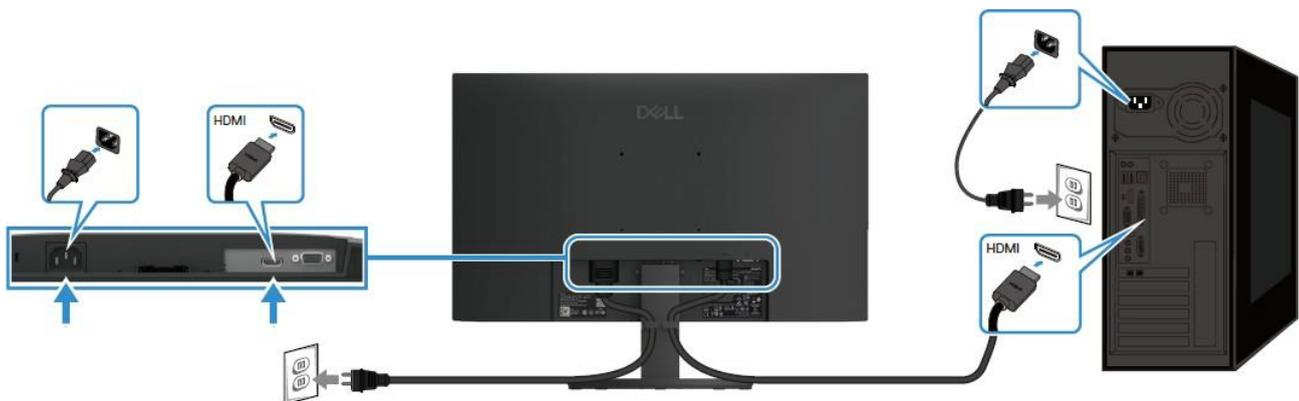
Figure 8. Connexion du câble HDMI
