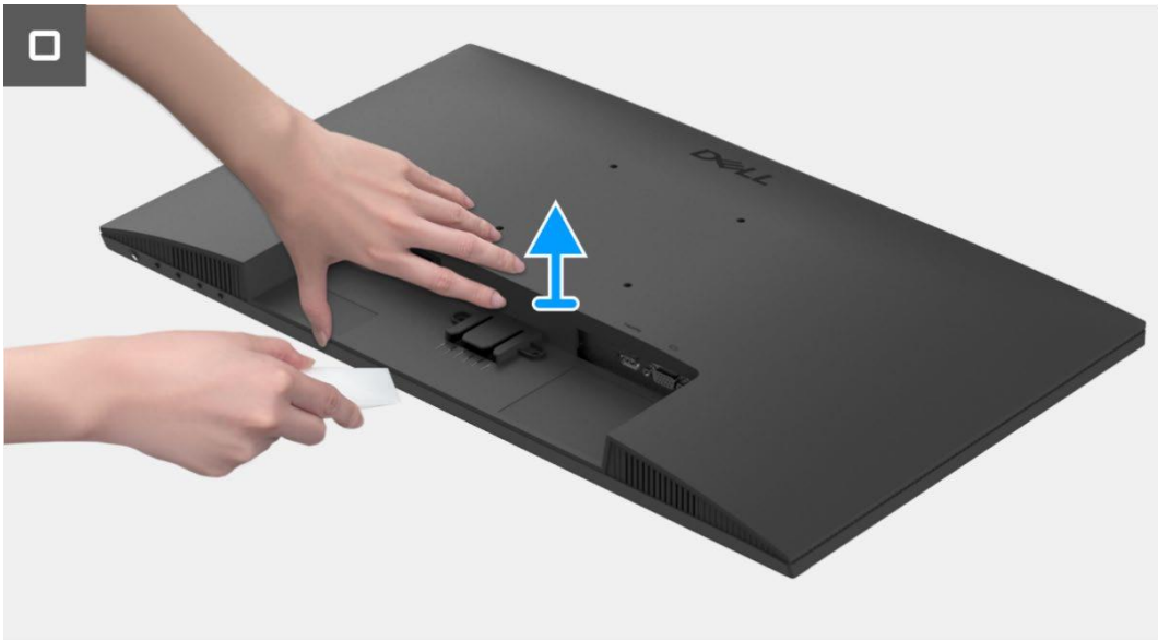
Figure 4. Retrait du couvercle arrière
