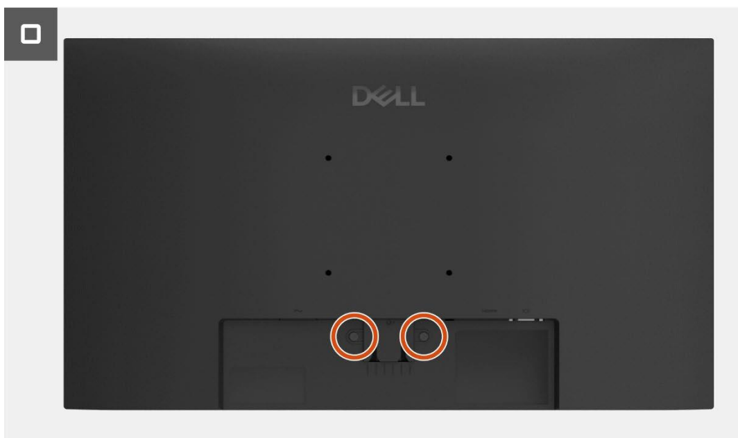
Figure 5. Installation du couvercle arrière
