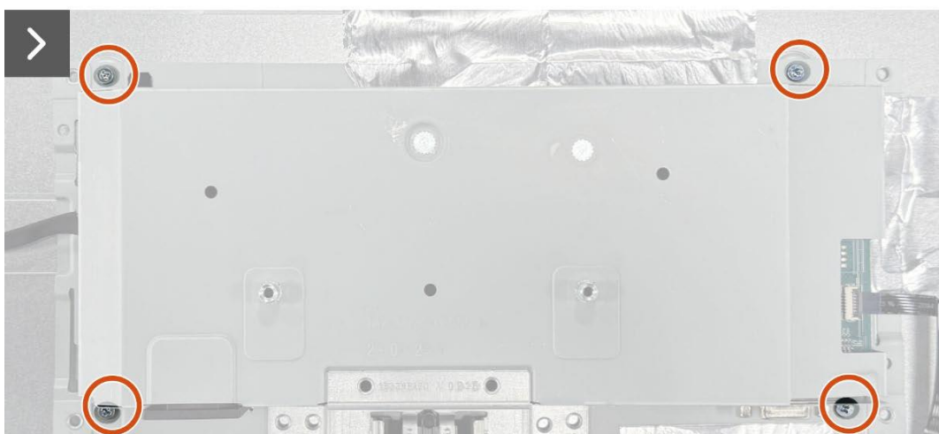
Figure 8. Installation de l'assemblage du cadre
