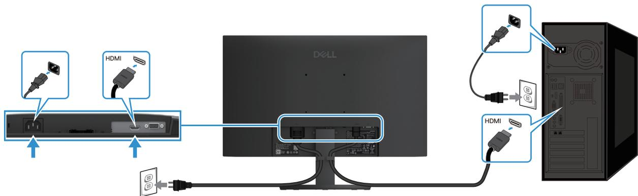
Abbildung 15. Anschließen des HDMI-Kabels
