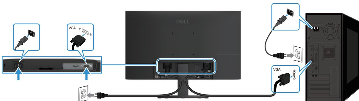
Abbildung 16. Anschließen des VGA-Kabels
