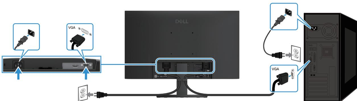
Figura 16. Conectar el cable VGA
