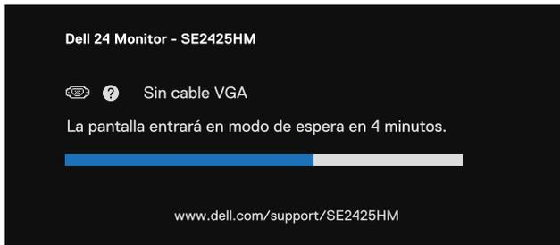
**Figura 37. Mensaje de advertencia de cable VGA desconectado**
