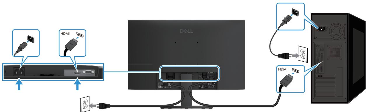
Figura 15. Conectar el cable HDMI
