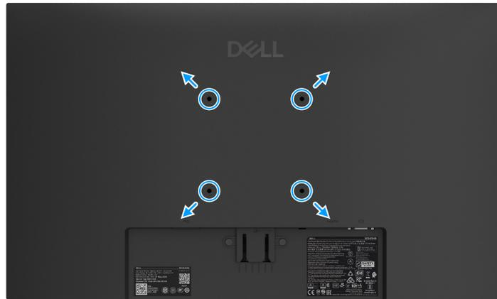
**Figura 22.** Instalación en pared VESA
