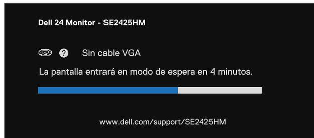
**Figura 39. Advertencia de cable VGA desconectado**
