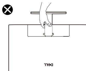
**Figura 10. No colocar el monitor boca abajo**
