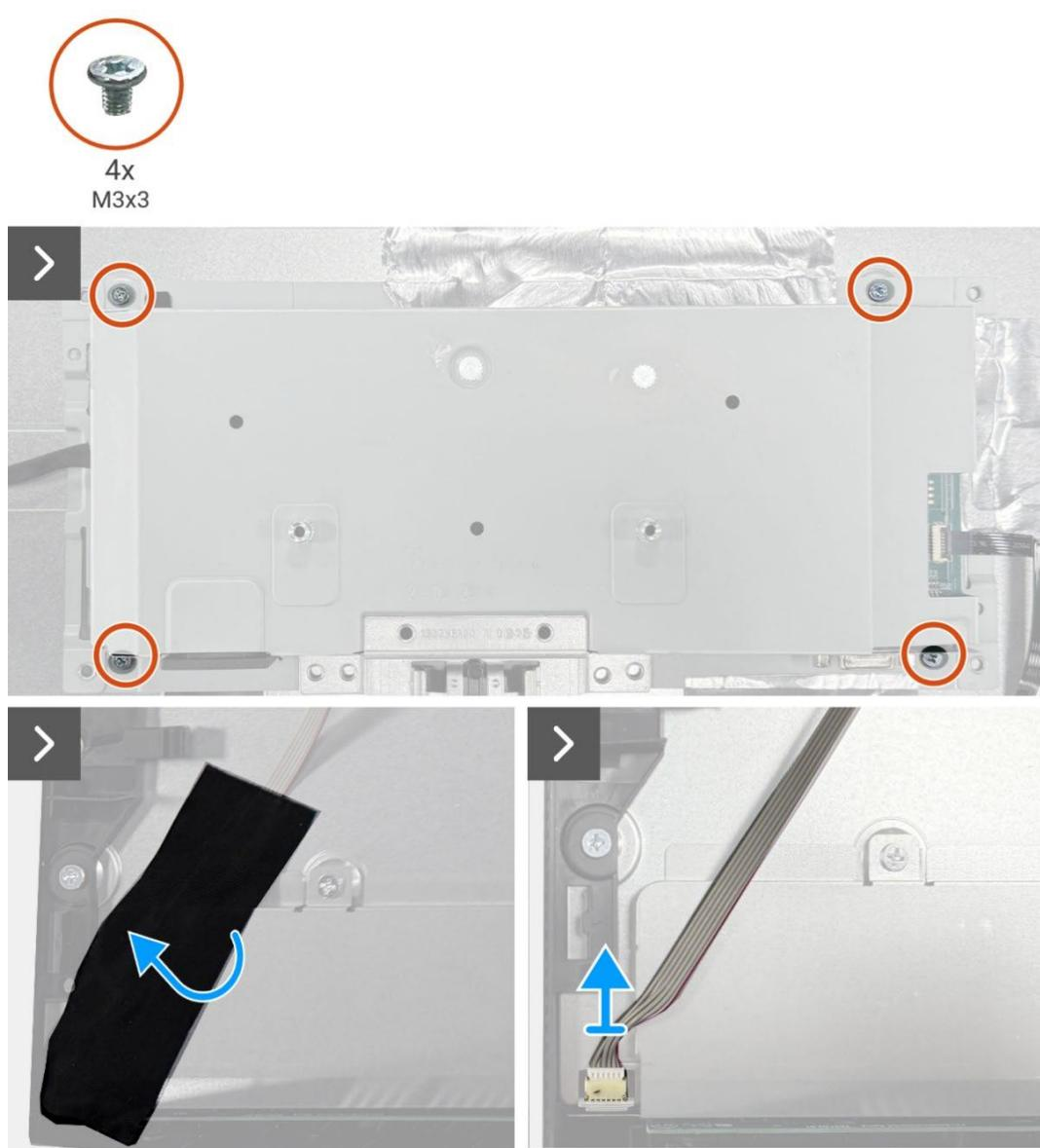
**Imagen 15.** Extracción del ensamblaje del chasis
