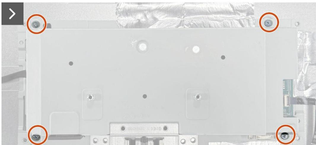
**Imagen 17.** Instalación del ensamblaje del chasis
