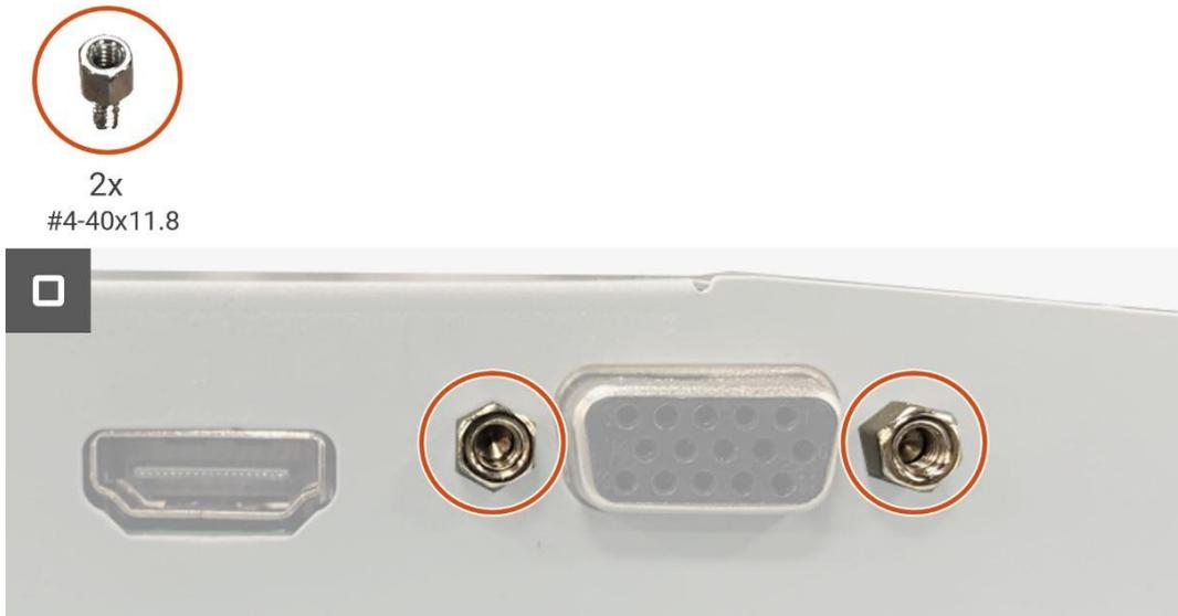
**Imagen 26.** Instalación de la placa de la interfaz
