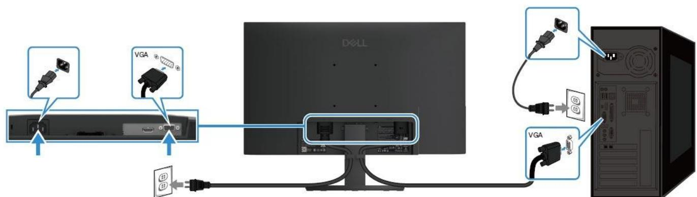
Imagen 9. Conectar el cable VGA
