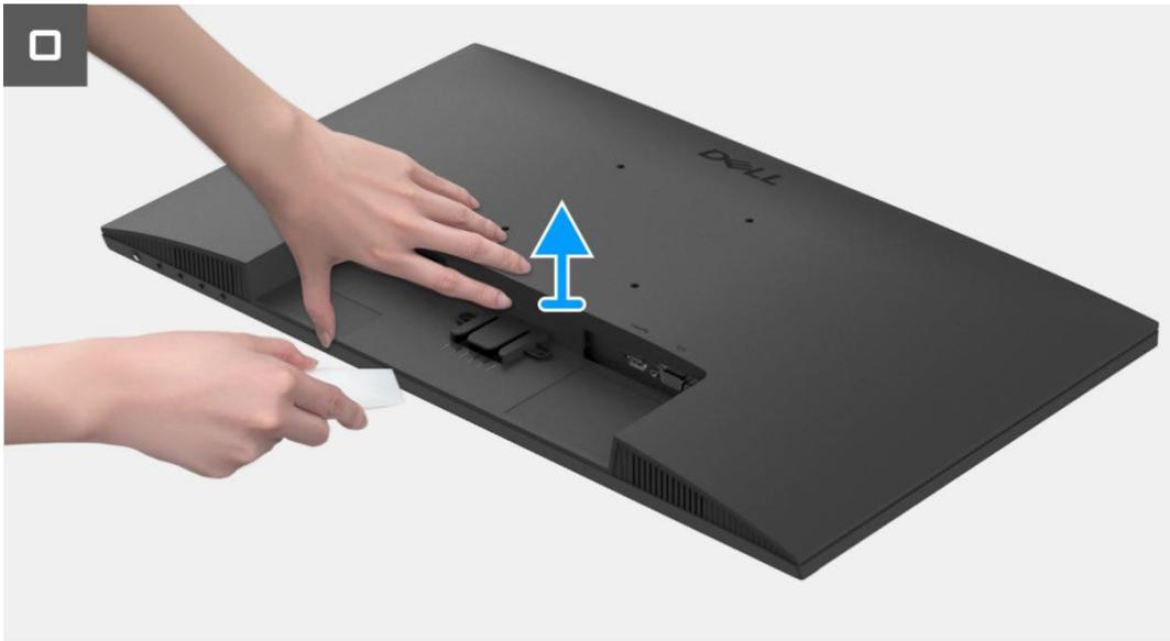
**Imagen 13.** Extracción de la cubierta trasera
