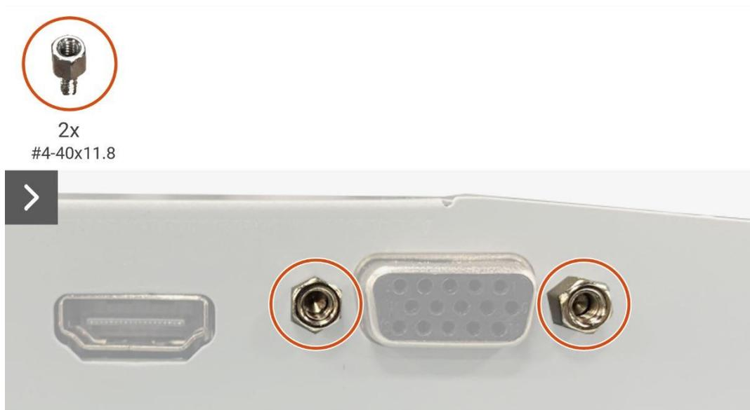
**Imagen 21.** Extracción de la placa de la interfaz
