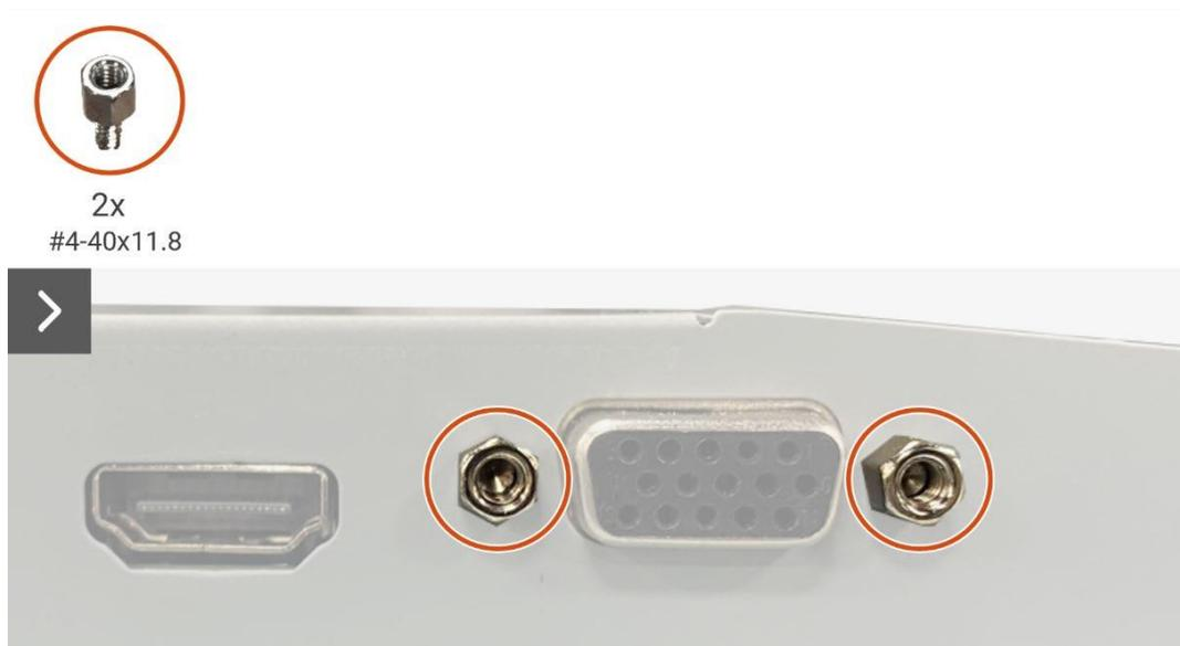
**Imagen 12.** Extracción de la placa de la interfaz
