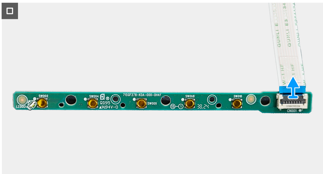
Rysunek 19. Zdejmowanie płyty klawiatury
