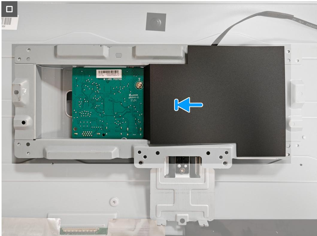
**Figura 24.** Installazione della scheda di sistema e della scheda di alimentazione
