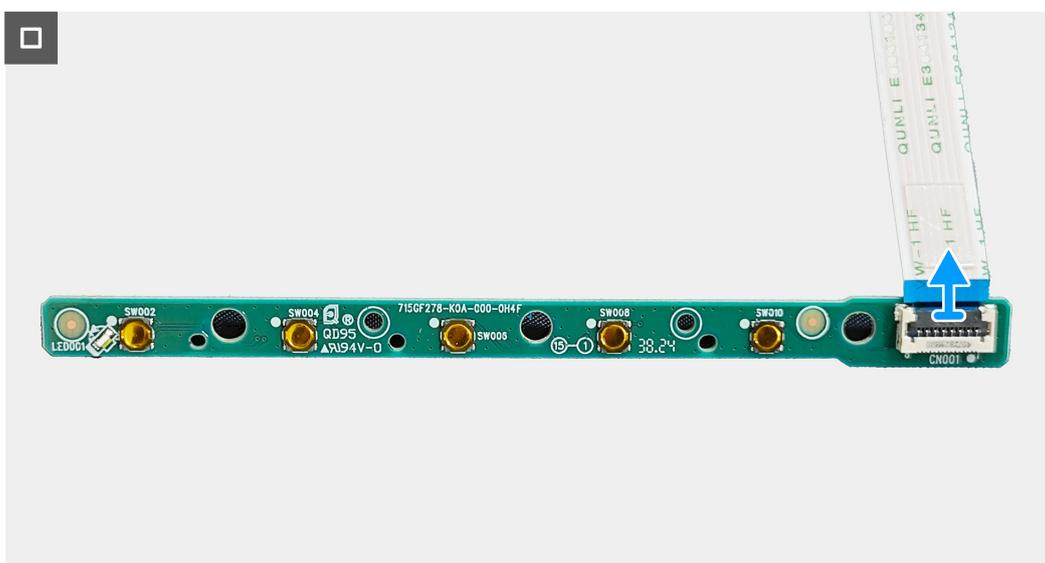
**Figura 19.** Rimozione della scheda del tastierino
