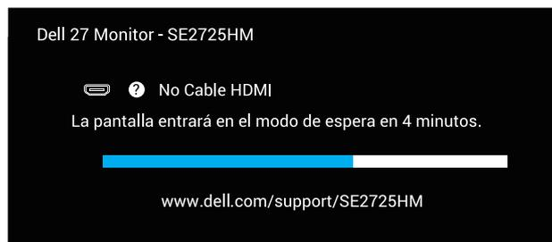
**Figura 40. Mensaje de ausencia de cable HDMI**
