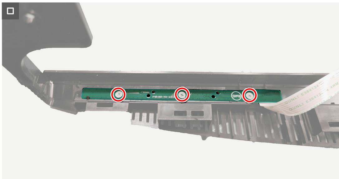
**Figura 12.** Instalar la placa del teclado
