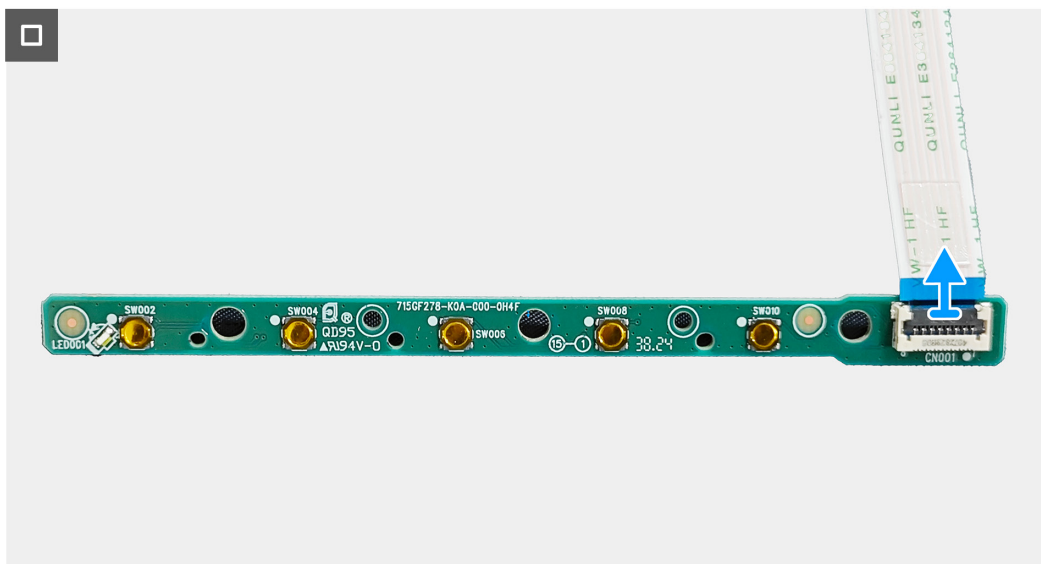
Obrázek 19. Demontáž tlačítkové desky
