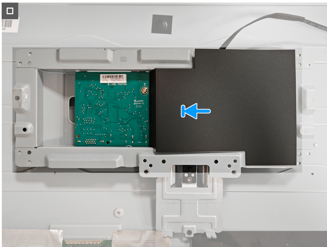
Obrázek 24. Instalace systémové desky a napájecí desky
