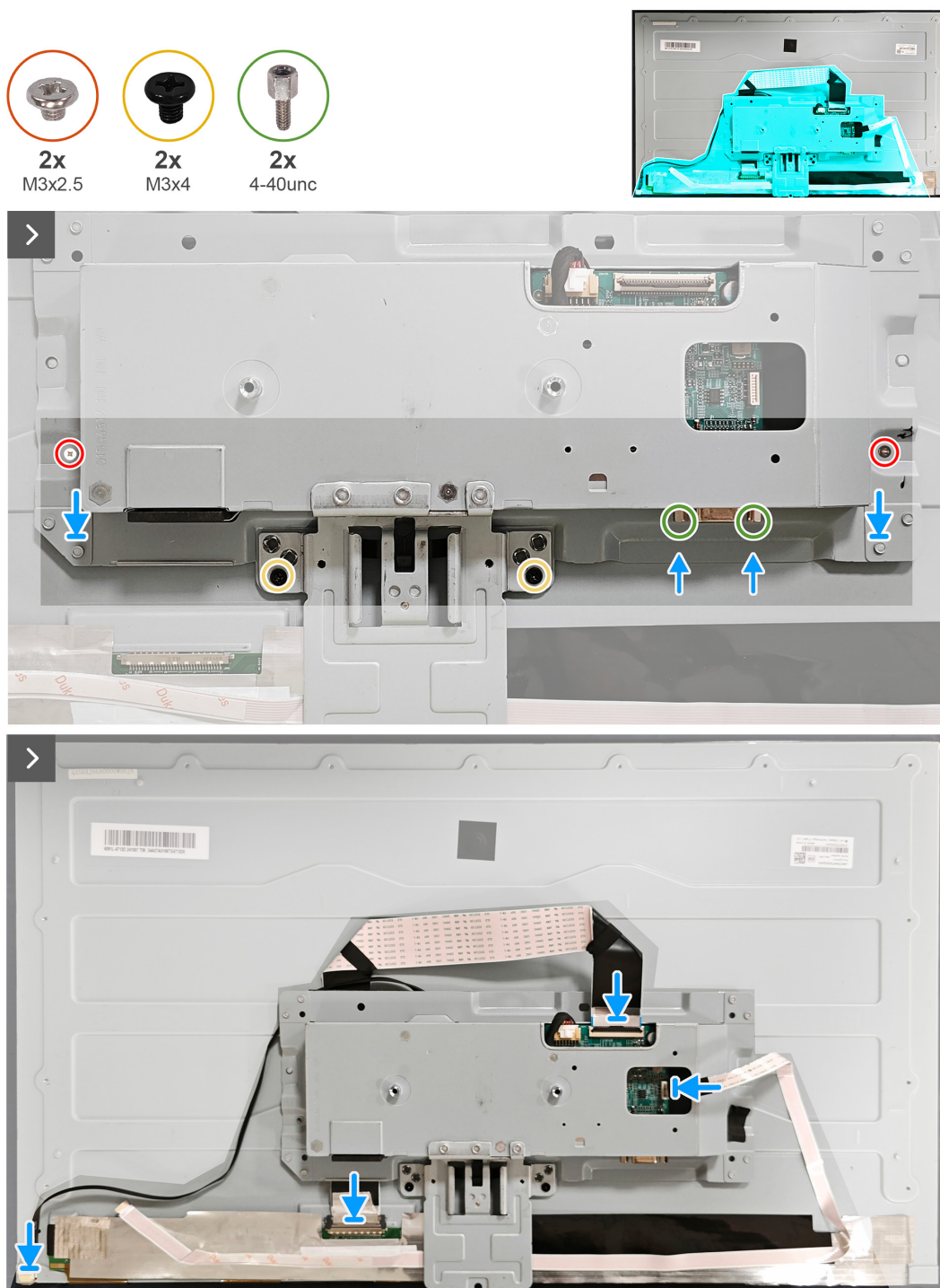
Figure 9. Installer le blindage métallique
