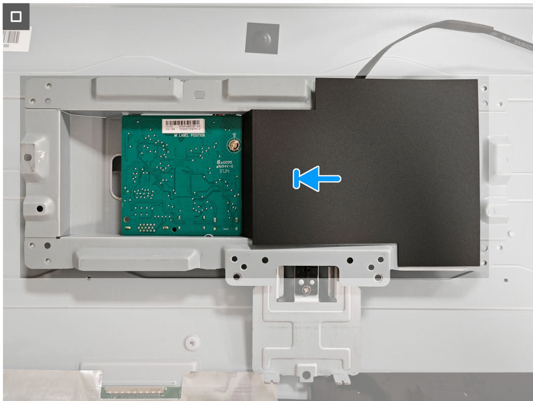
Figura 16. Instalar la placa del sistema y la placa de alimentación
