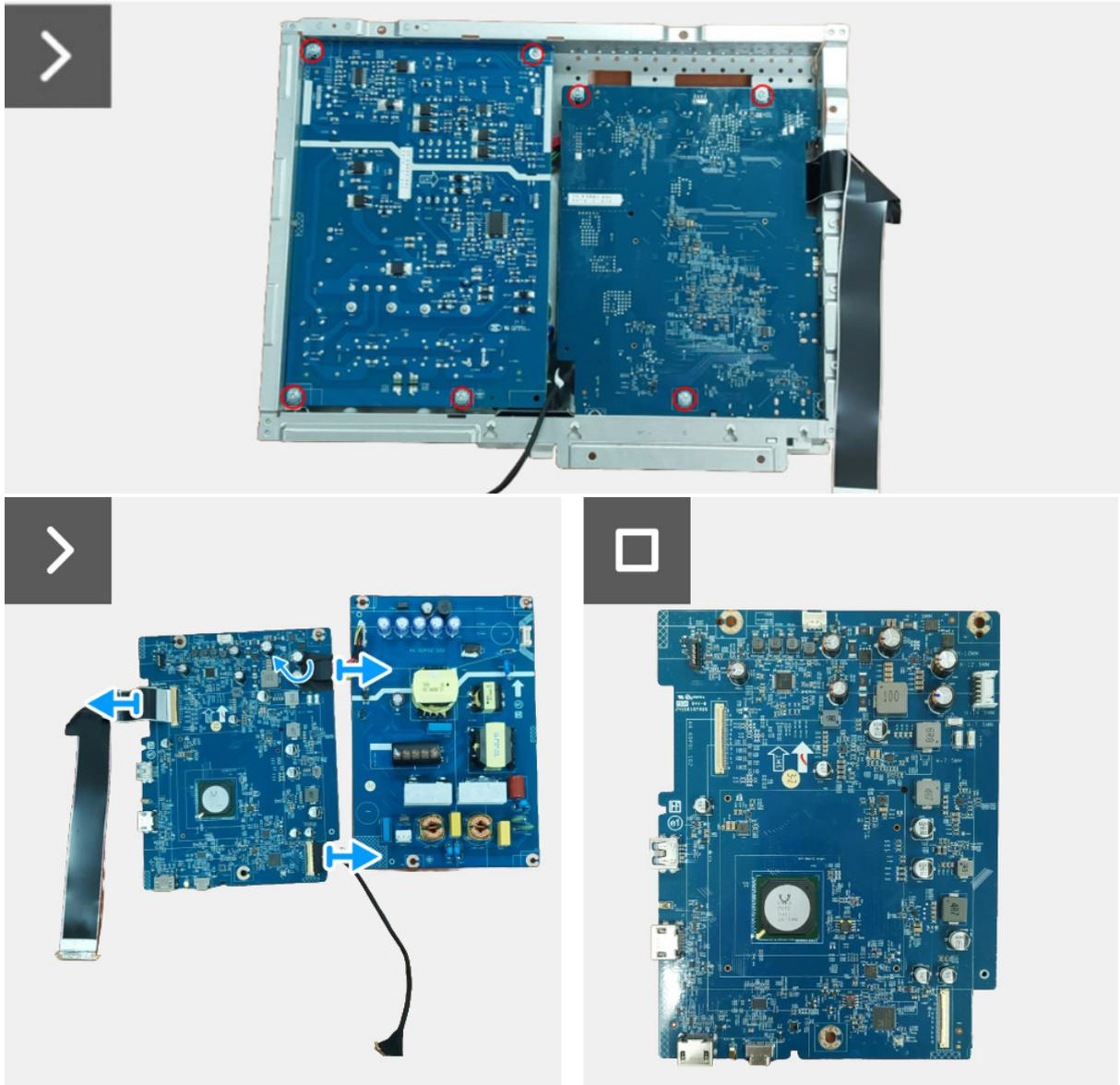
Figura 12. Remover a placa de interface
