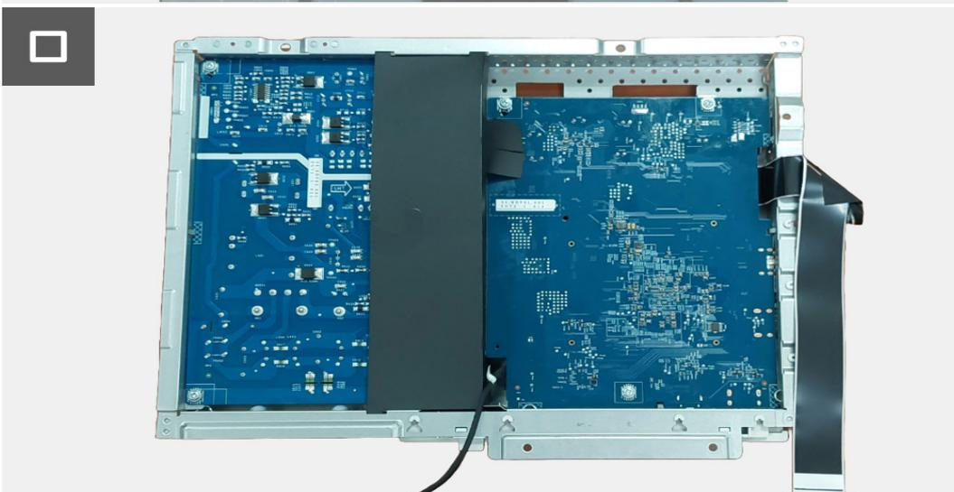
**Figura 8.** Remover a placa de interface
