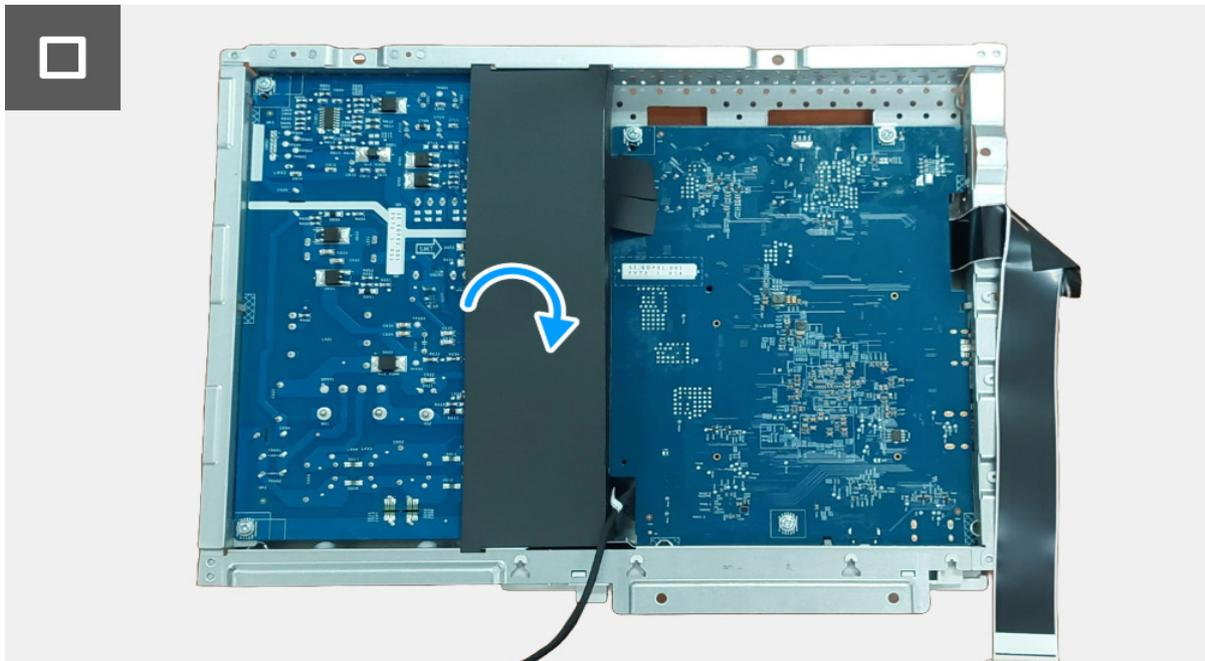
**Figura 14.** Instalar a placa de interface
