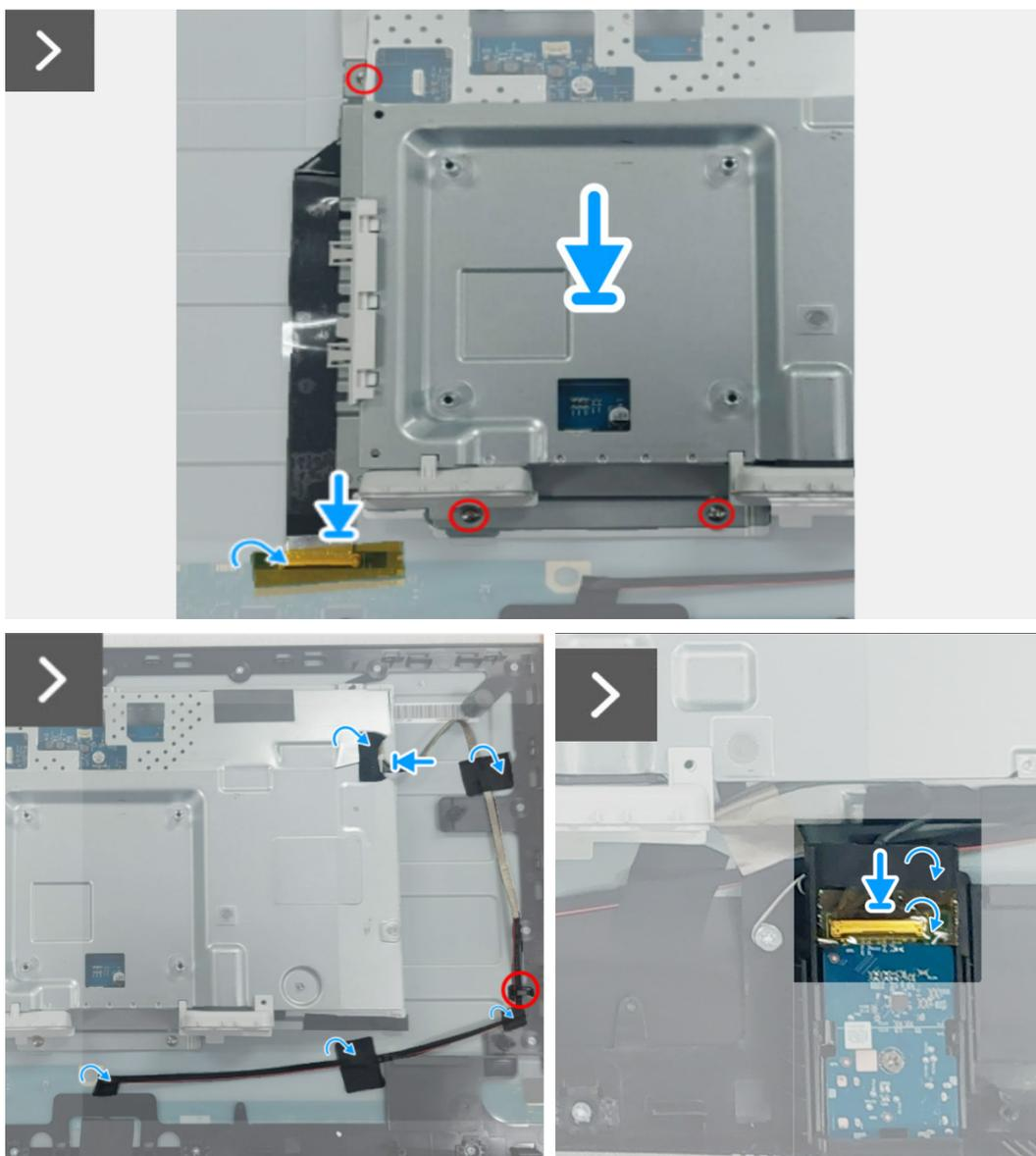
Figura 9. Instalar a placa de interface
