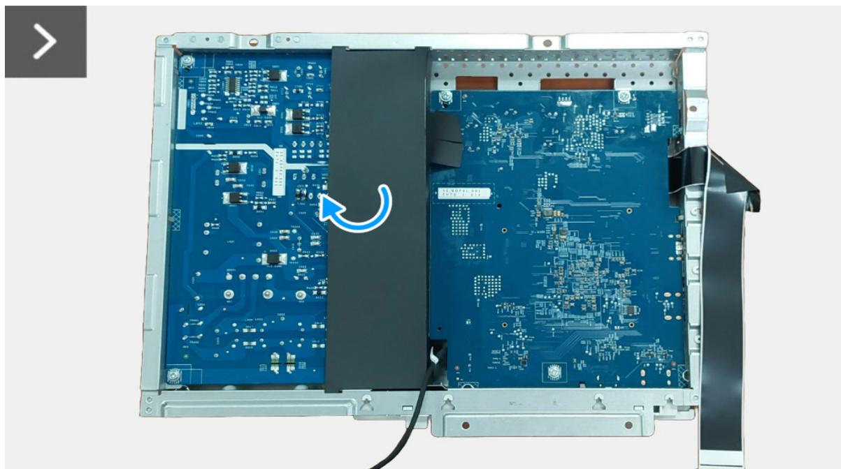
**Figura 11.** Remover a placa de interface
