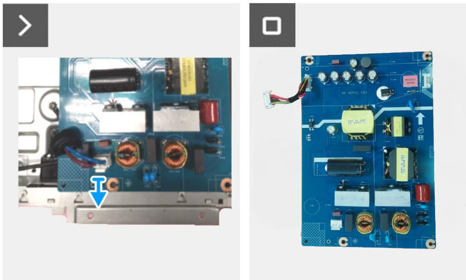
Figura 15. Remover a placa de alimentação
