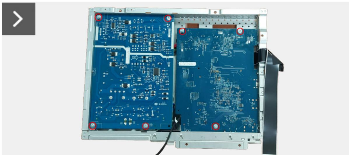
**Figura 13.** Instalar a placa de interface
