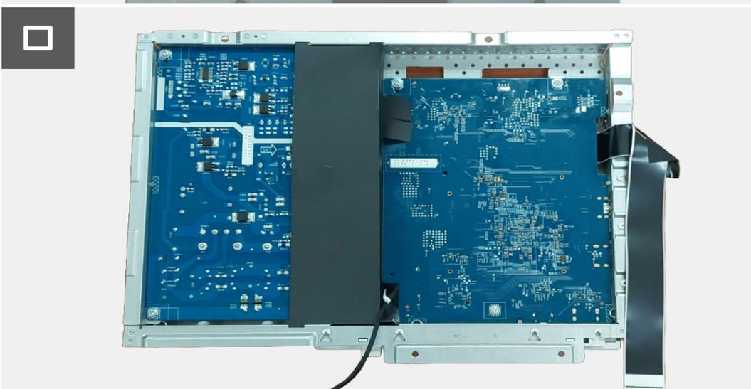
**Figura 17. Remover a placa de interface**
