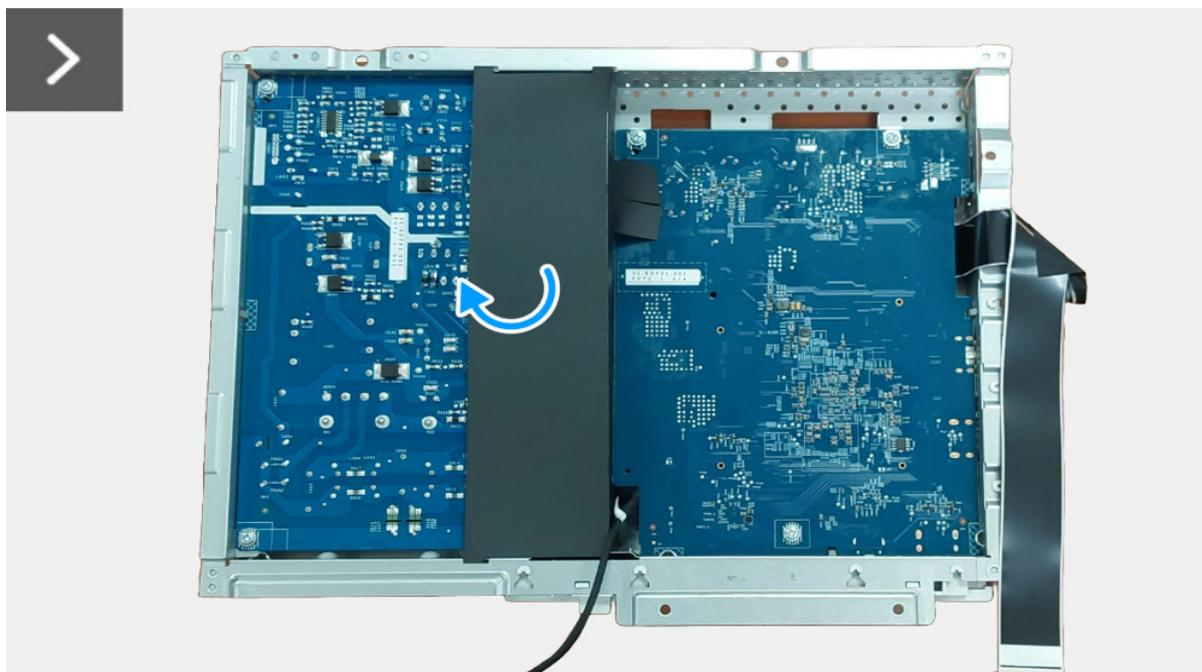
**Figura 20.** Remover a placa de interface
