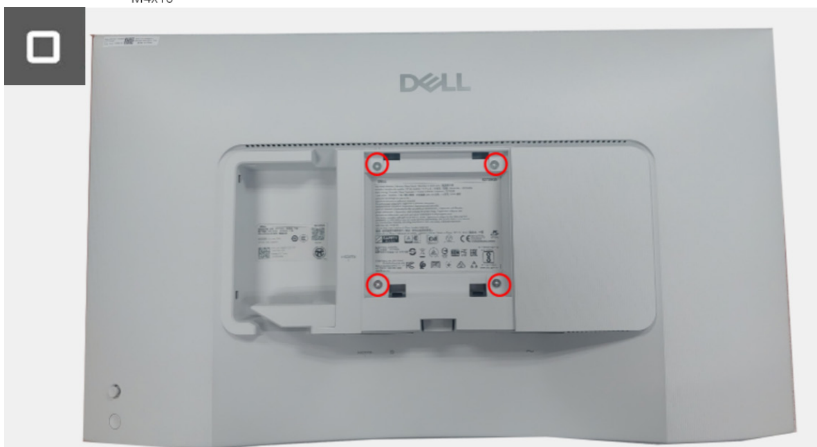
Figura 15. Instalar la cubierta posterior
