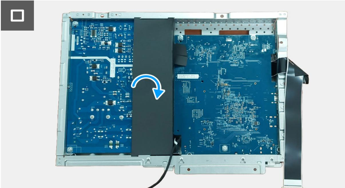
**Figura 14.** Instalar la placa de la interfaz
