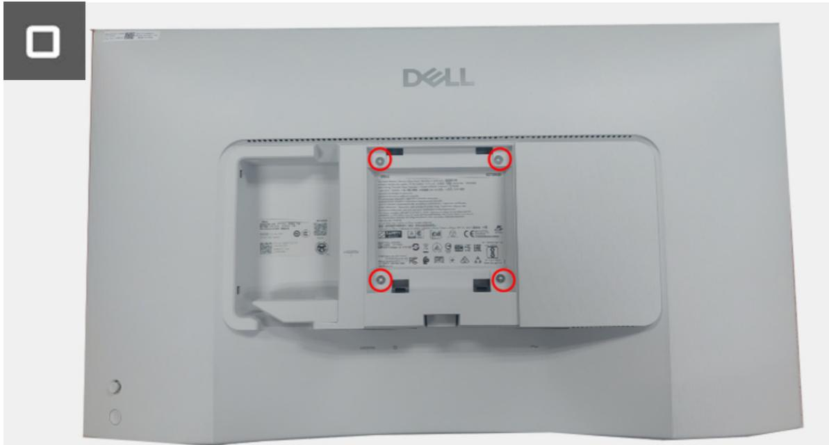
**Figura 6. Instalar la cubierta posterior**
