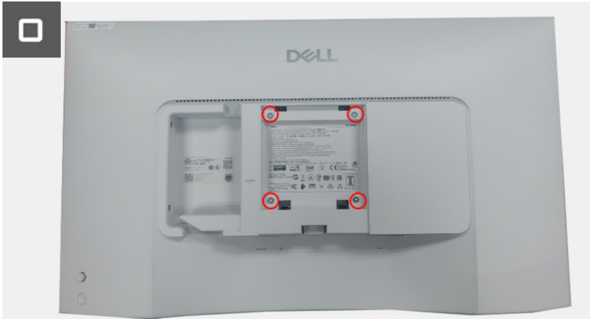
Figure 15. Installer le couvercle arrière
