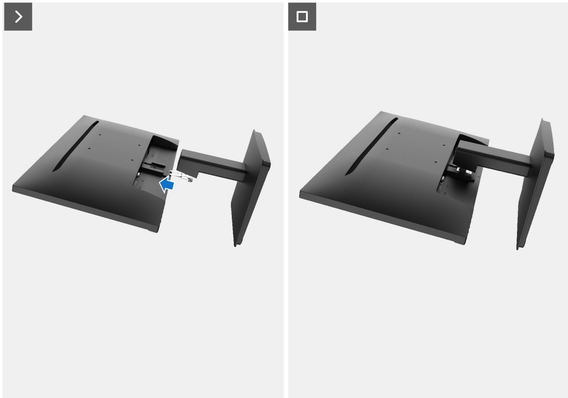
Figura 2. Instalar el soporte
