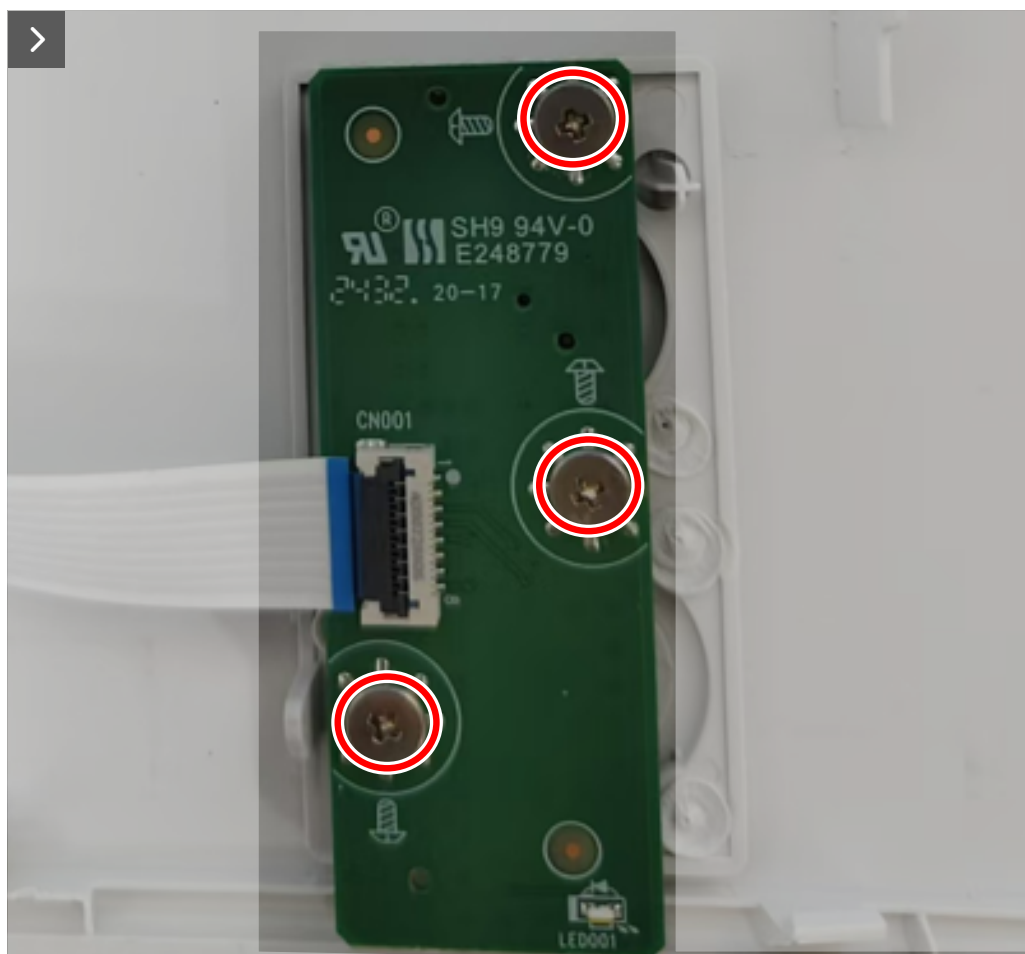
Rysunek 27. Odkręcenie śrub
