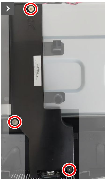
Rysunek 7. Odkręcanie śrub
