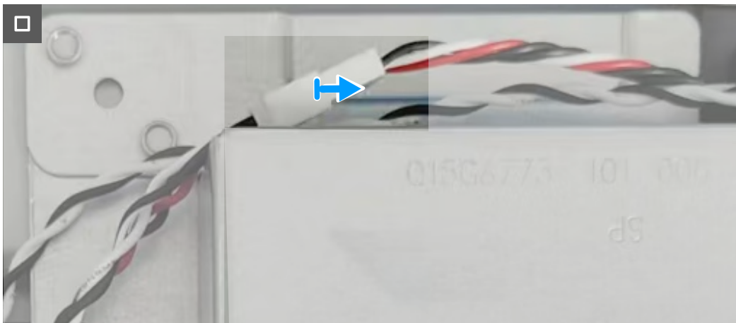
Rysunek 8. Odłączenie kabla głośnika
