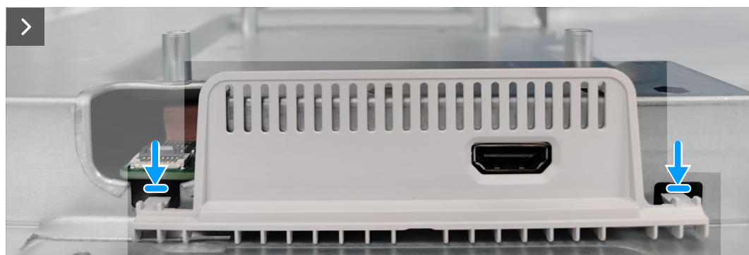
Rysunek 23. Założenie metalowej osłony pokrywy We/Wy
