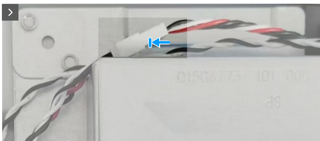
Rysunek 9. Podłączenie kabla głośnika
