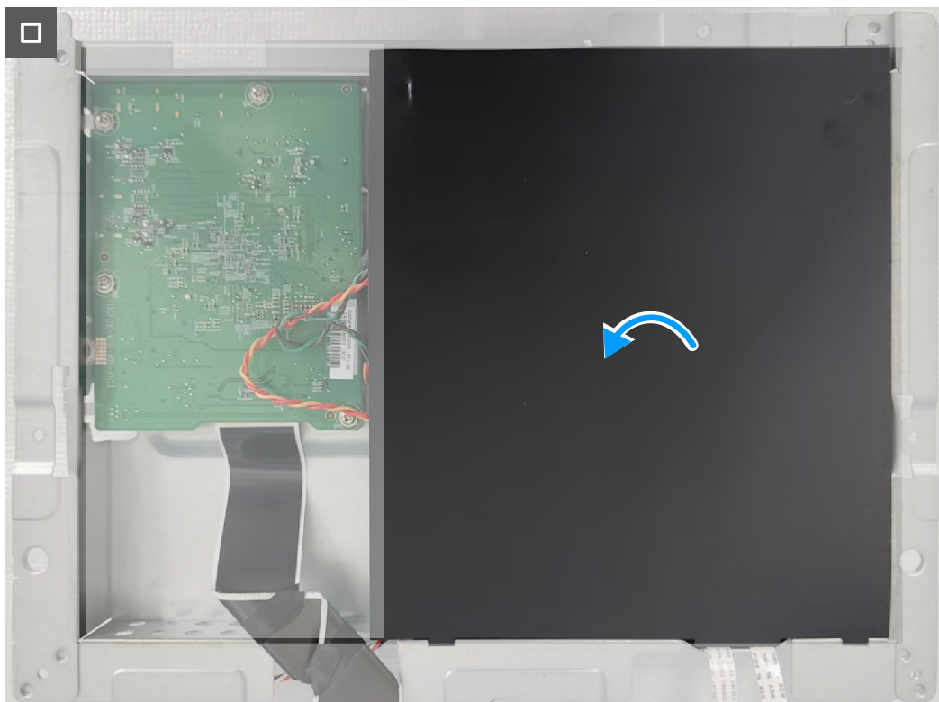
Figura 24. Colocar a película Mylar
