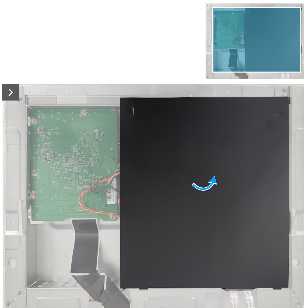
Figura 17. Remover a película Mylar
