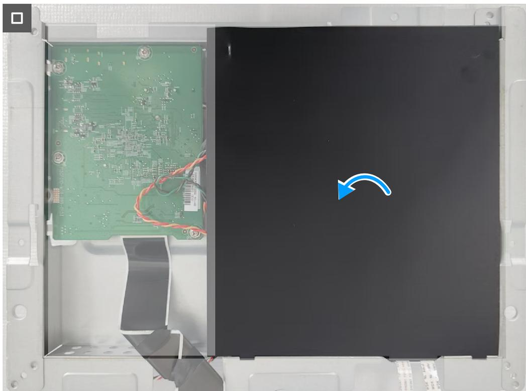
**Figura 24. Posizionamento del foglio mylar**
