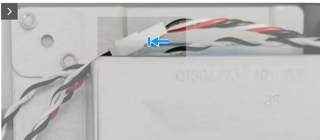
**Figura 9. Collegamento del cavo altoparlante**
