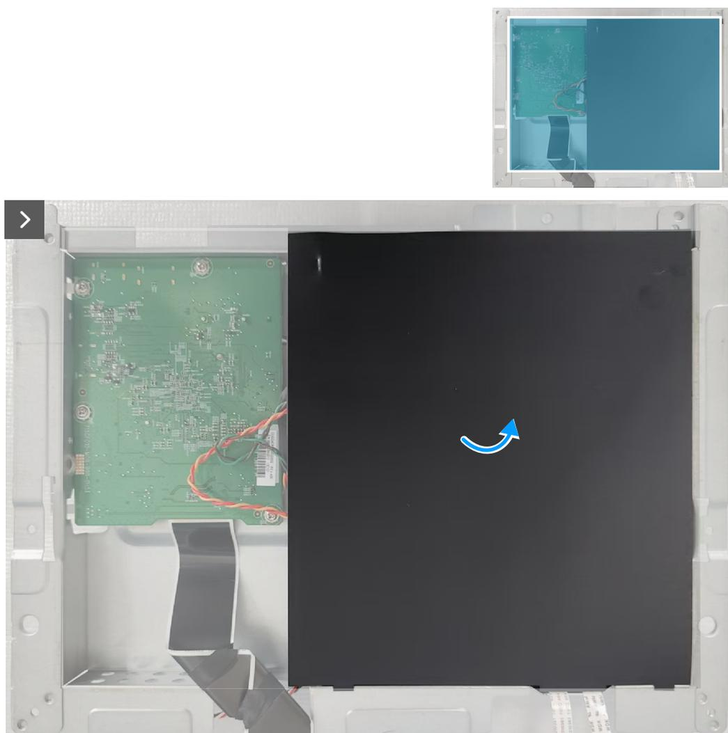
**Figura 17.** Rimozione del foglio mylar
