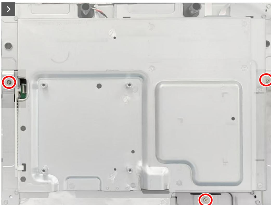
**Figura 12.** Rimozione delle viti
