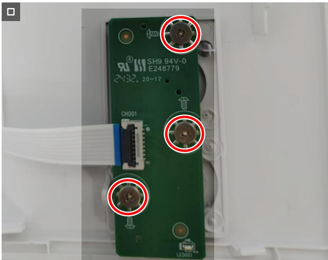
**Figura 30. Riposizionamento delle viti**
