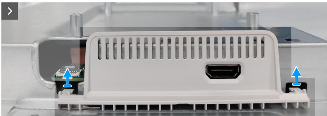
**Figura 18.** Rimozione del coperchio I/O della schermatura metallica
