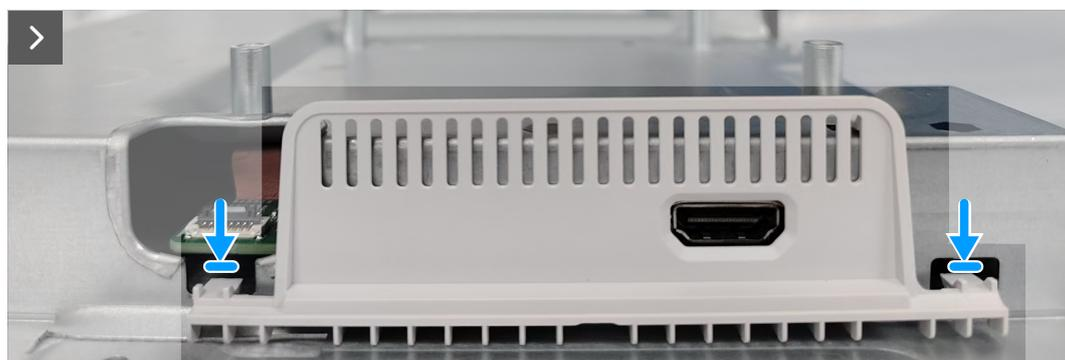
**Figura 23.** Riposizionamento del coperchio I/O della schermatura metallica
