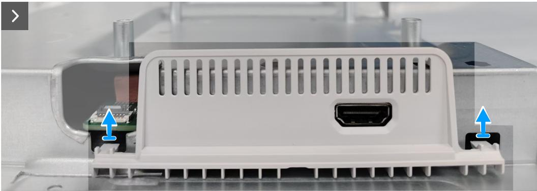
**Figura 18.** Retirar la cubierta de E/S de la protección metálica
