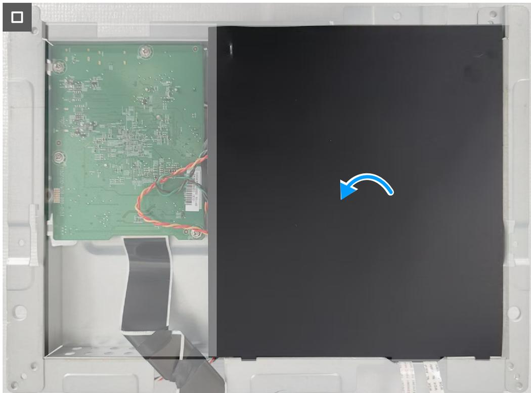
**Figura 24. Colocar la lámina Mylar**
