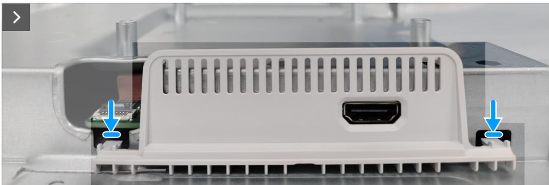
**Figura 23.** Volver a colocar la cubierta de E/S de la protección metálica
