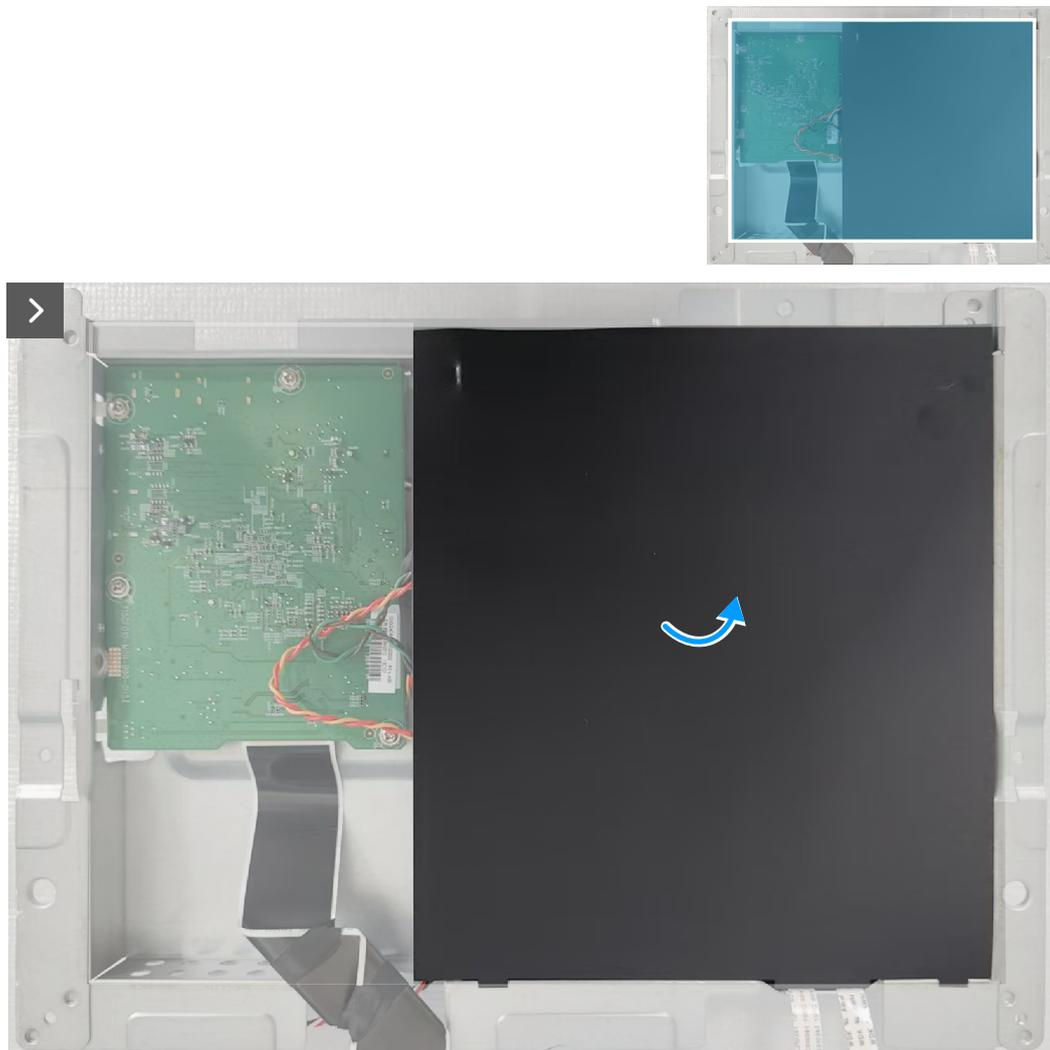
**Figura 17.** Retirar la lámina Mylar
