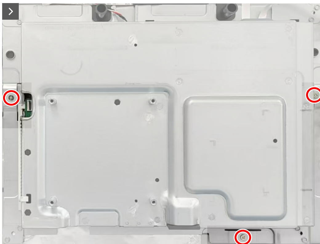
Figura 27. Volver a colocar los tornillos
