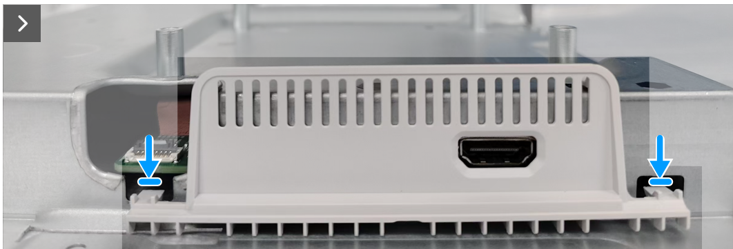
Figura 35. Volver a colocar la cubierta de E/S de la protección metálica
