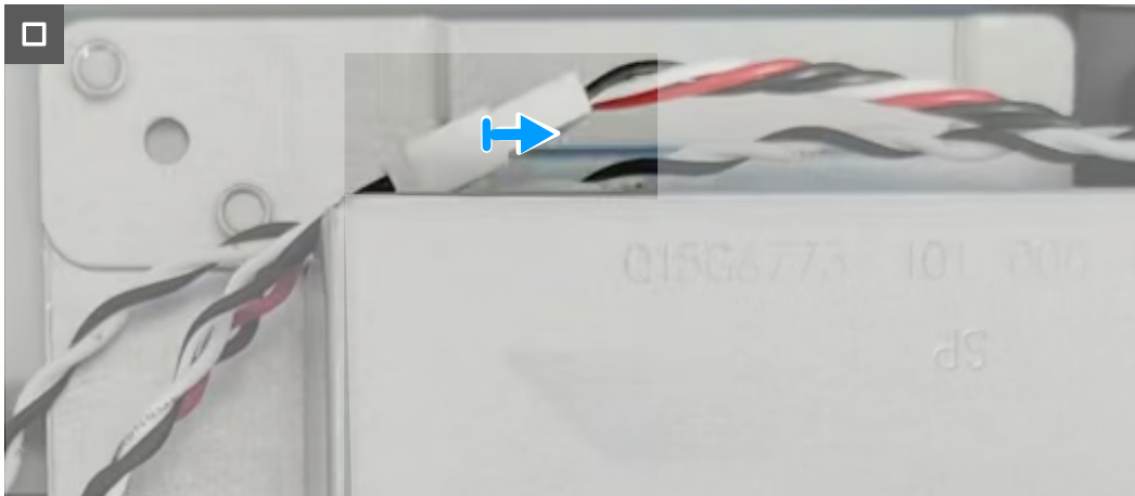
Figura 20. Desconectar el cable del altavoz
