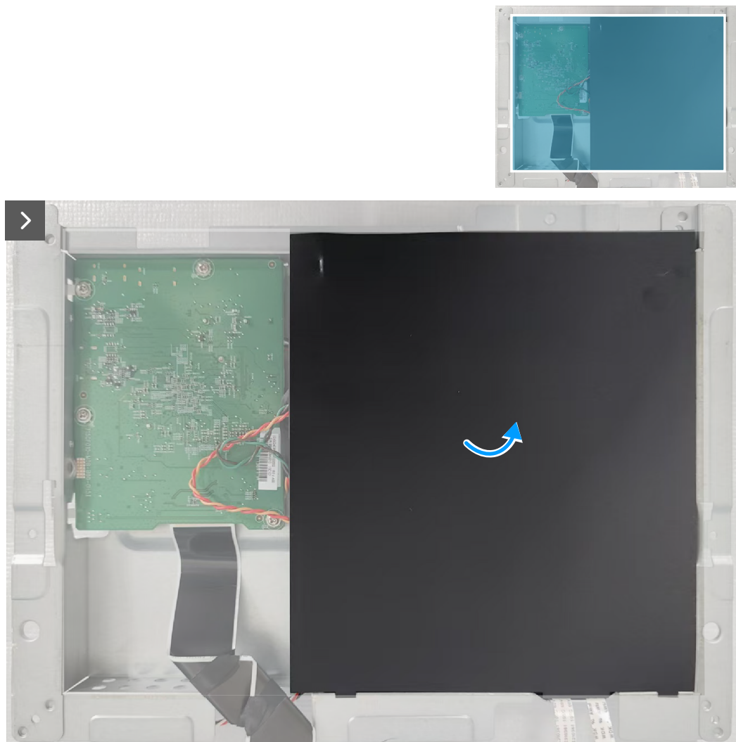
Figura 29. Retirar la lámina Mylar
