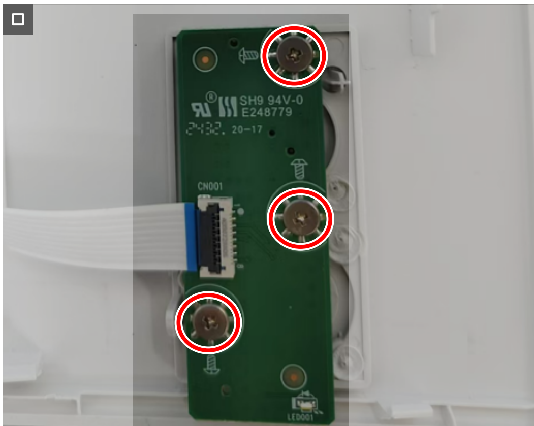
Figura 42. Volver a colocar los tornillos
