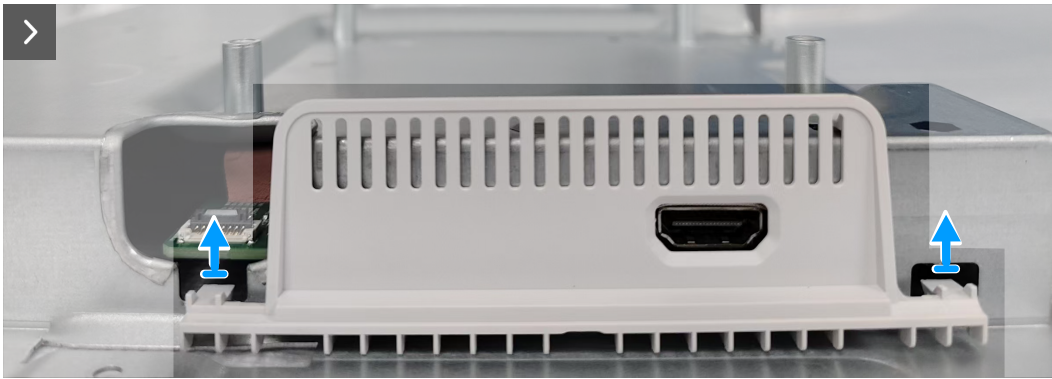
Figura 30. Retirar la cubierta de E/S de la protección metlica
