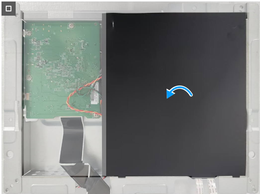
Figura 36. Colocar la lámina Mylar
