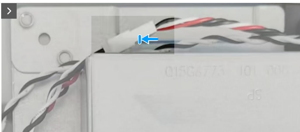
Figura 21. Conectar el cable del altavoz
