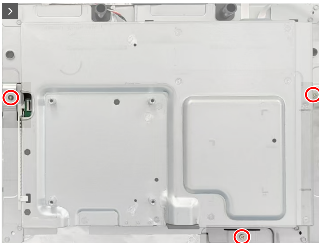
Figura 24. Retirar los tornillos
