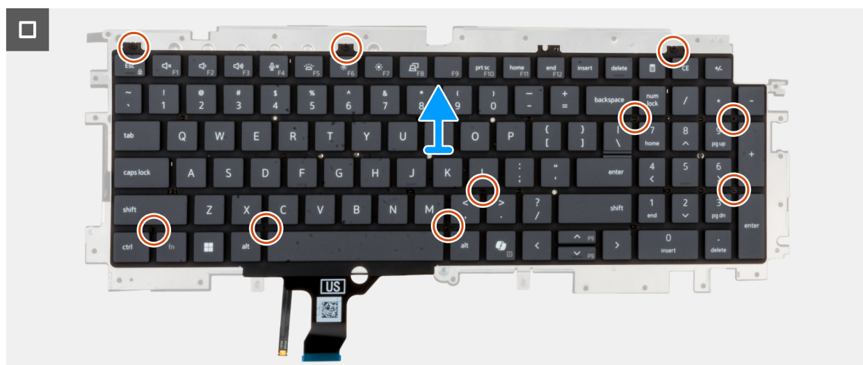
Rysunek 79. Wymontowywanie klawiatury
