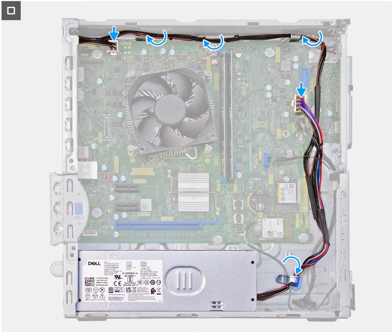
**Figura36. Instalar a unidade de fonte de alimentação**
