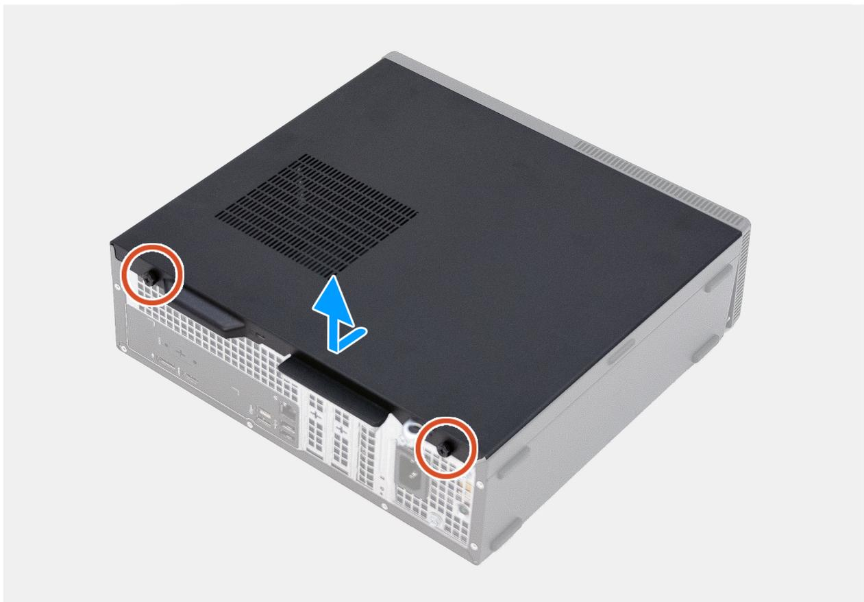
Figura11. Retirar a tampa do lado esquerdo
