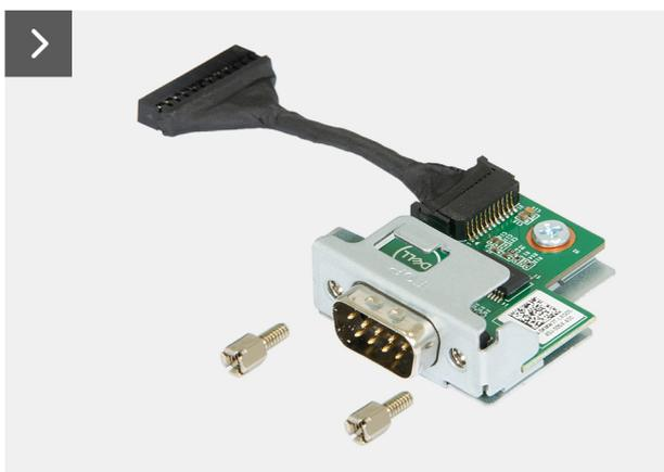
Figura46. Instalar o módulo da porta de série
