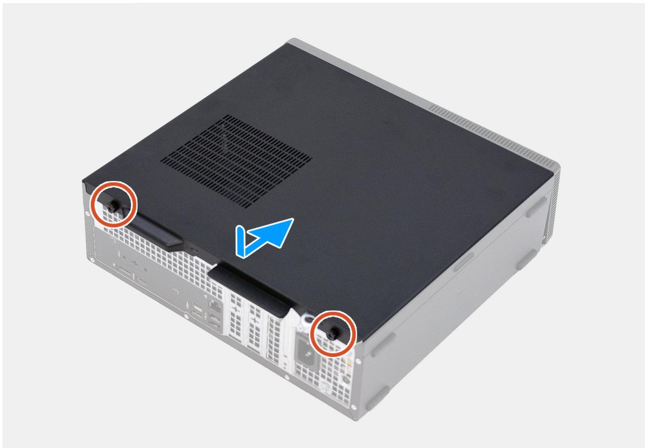
Figura12. Instalar a tampa lateral esquerda
