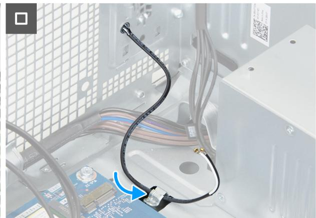
Figura32. Instalar o módulo da antena
