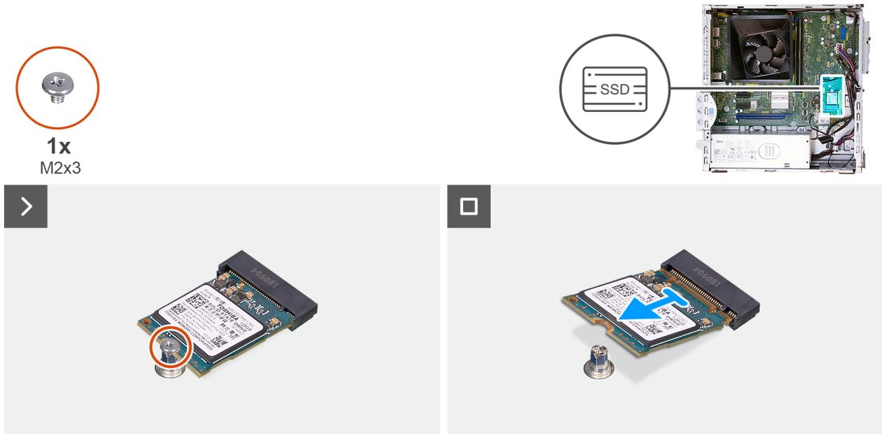
Figura25. Retirar o disco de estado sólido M.2 2230
