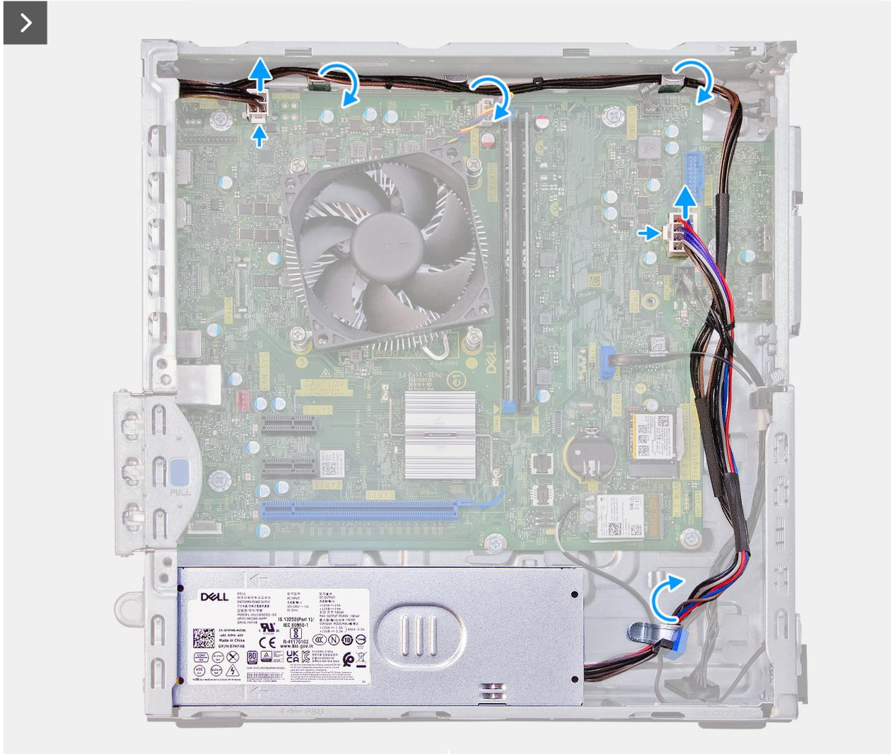
Figura33. Retirar a unidade de fonte de alimentação
