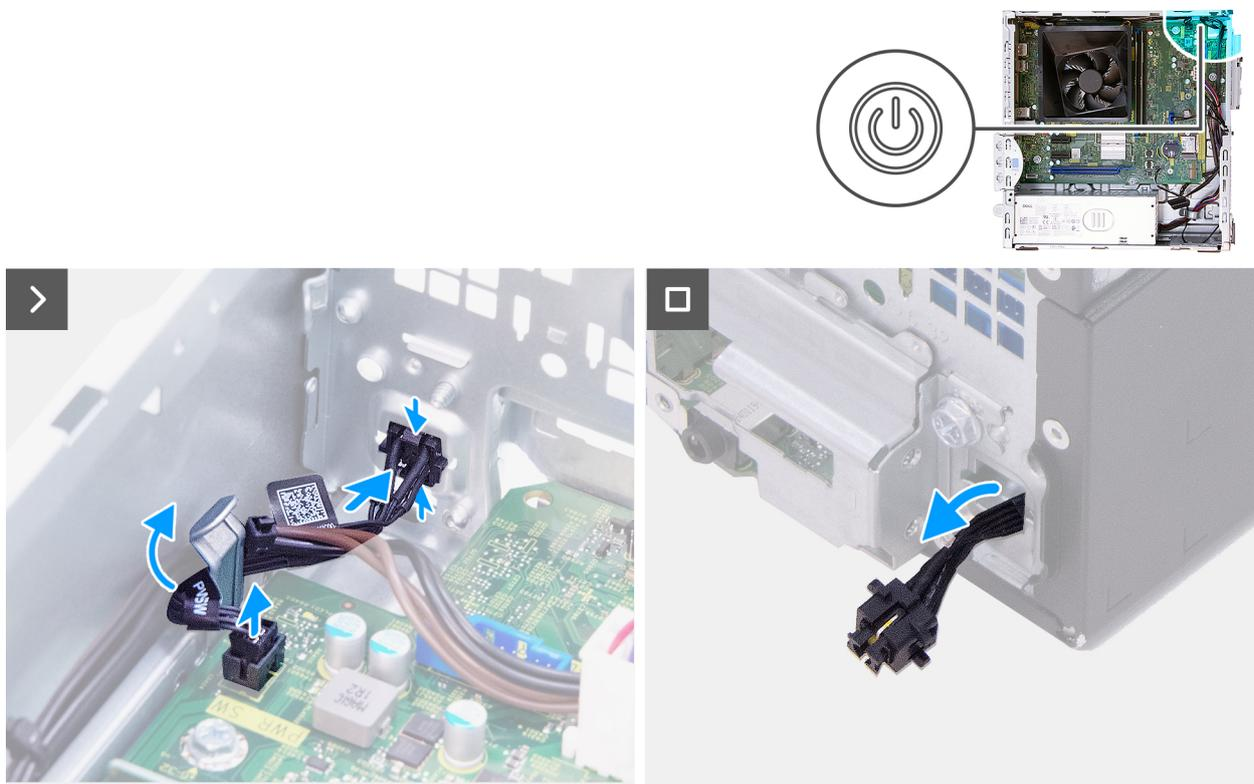
Figura 43. Rimozione del pulsante di accensione
