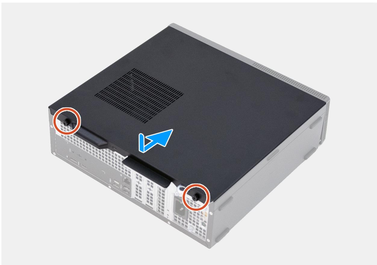
Figura 12. Installazione del pannello laterale sinistro
