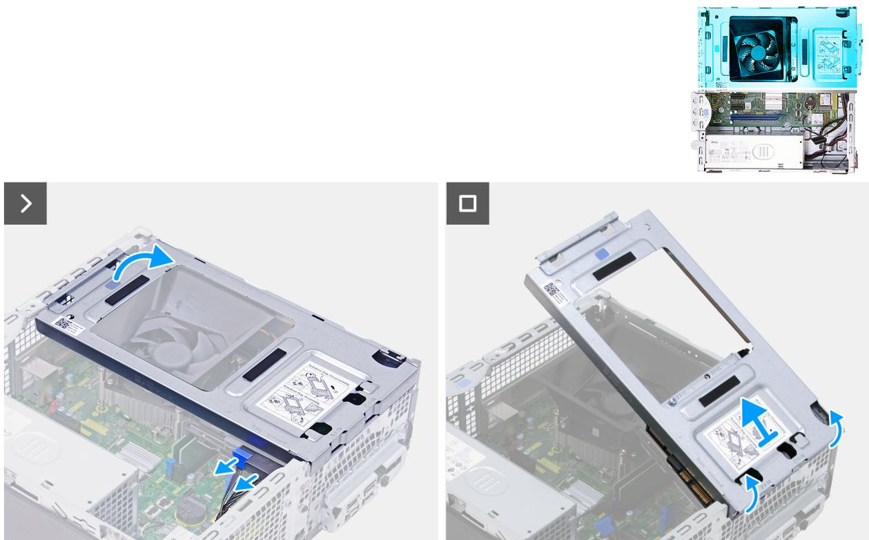
Figura 19. Rimozione dell'alloggiamento di rotazione
