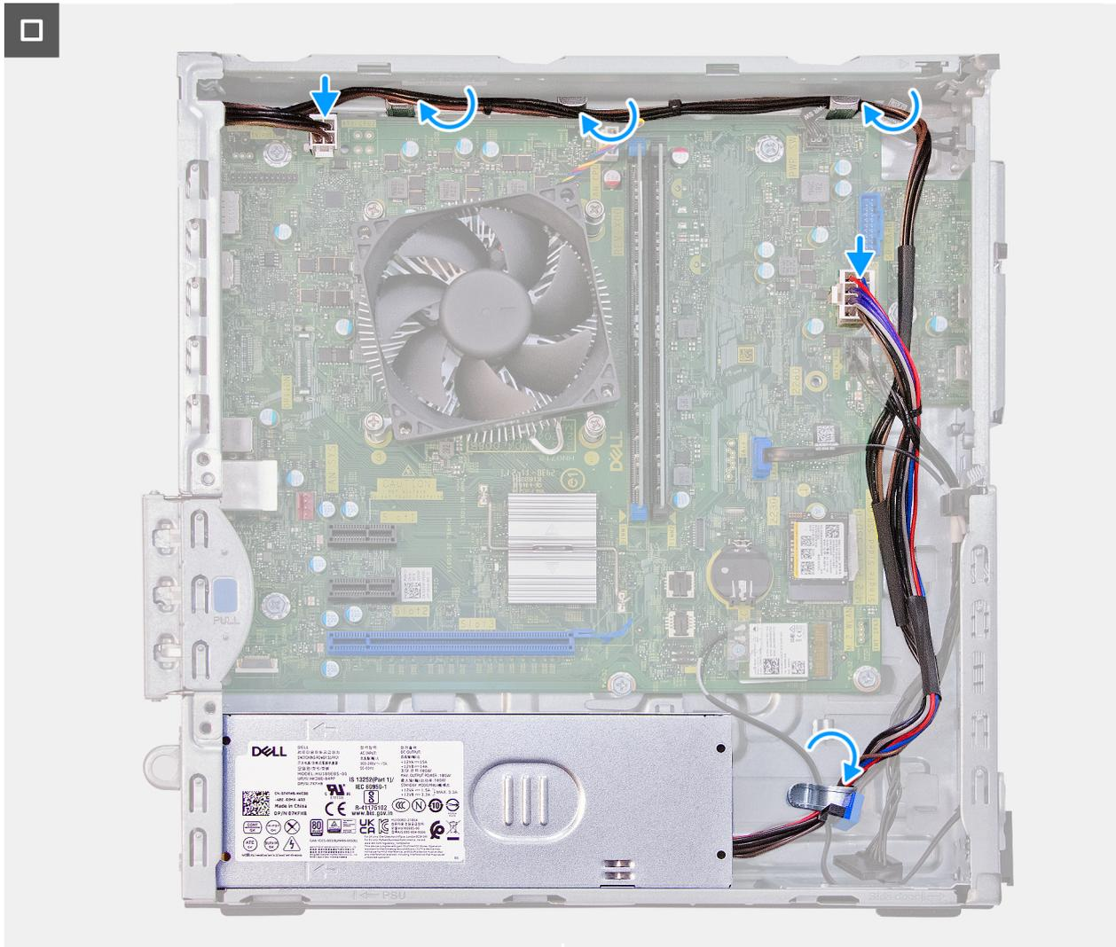
**Figura 36. Installazione dell'unità di alimentazione**
