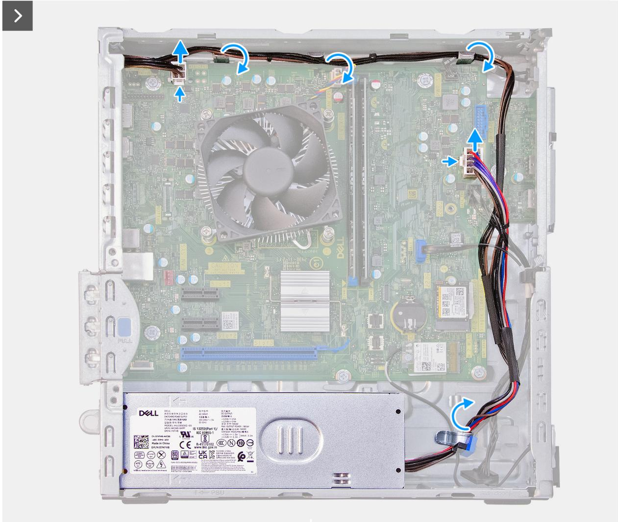
Figura 33. Rimozione dell'unità di alimentazione
