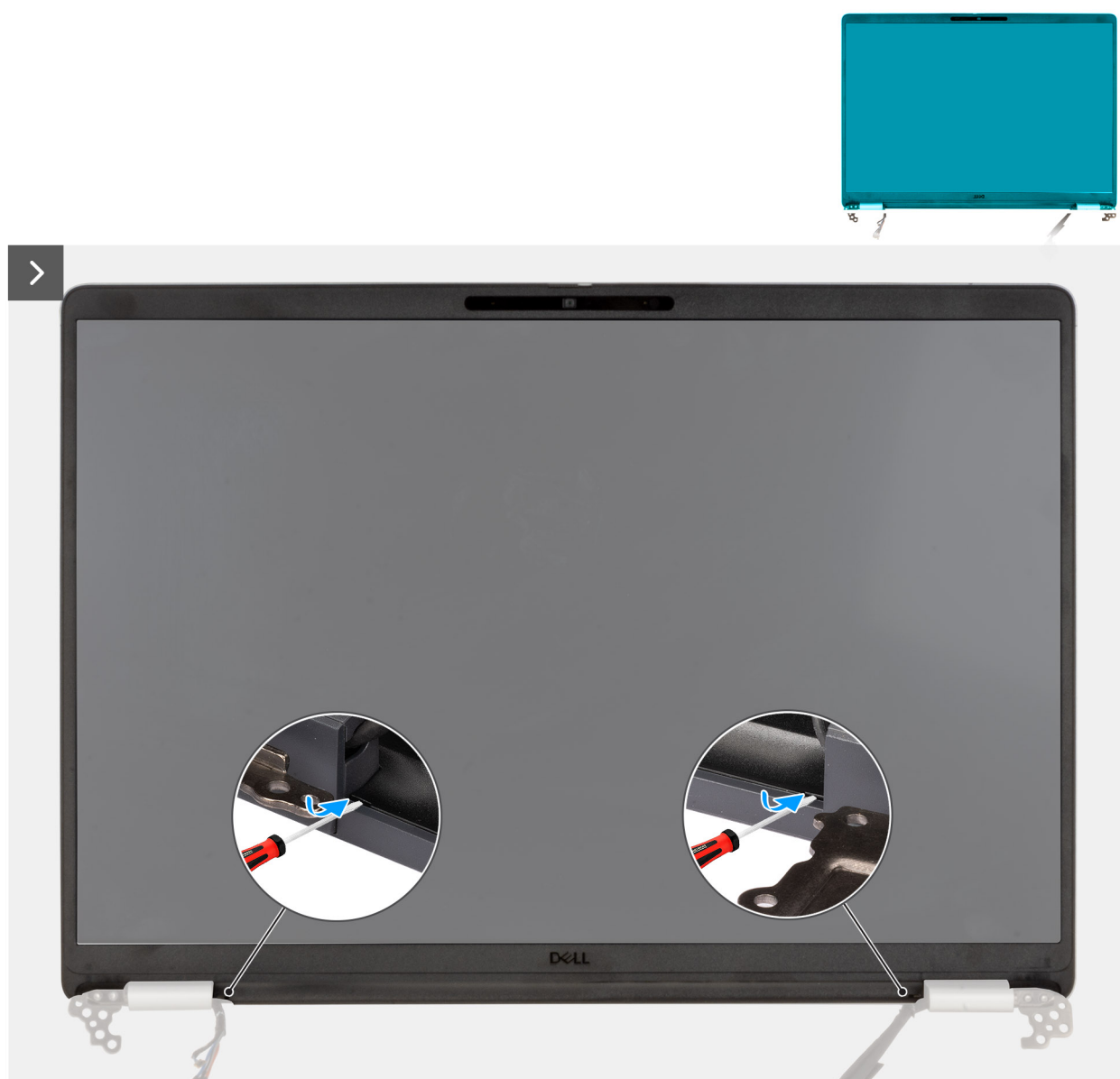
Obrázek 57. Uvolnění plastového čelního krytu
