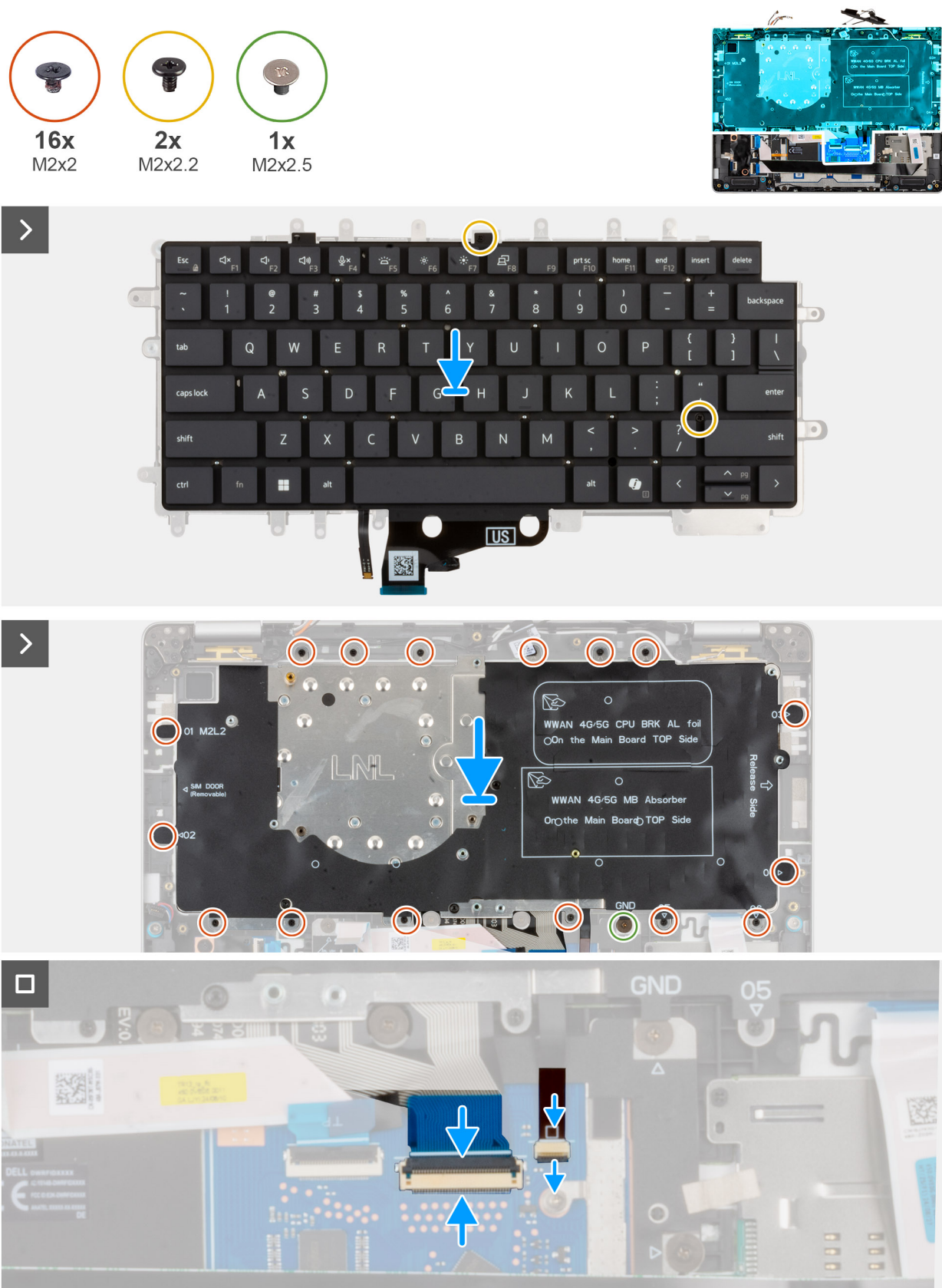
Obrázek 42. Montáž klávesnice
