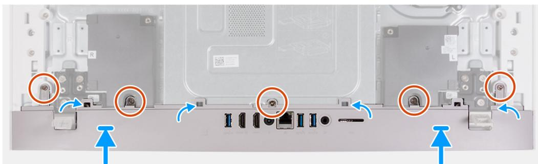
**Figura 24. Installazione del coperchio inferiore**
