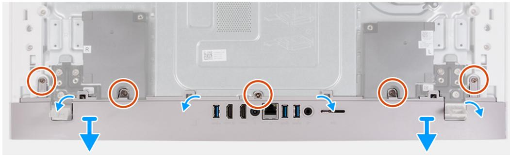
**Figura 23. Rimozione del coperchio di I/O**
