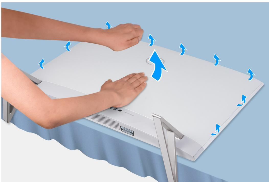
**Figura 21. Rimozione del coperchio posteriore**
