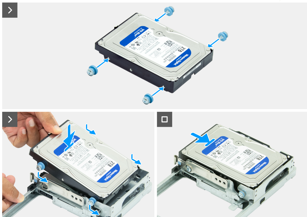
Obrázek 30. Montáž pevného disku
