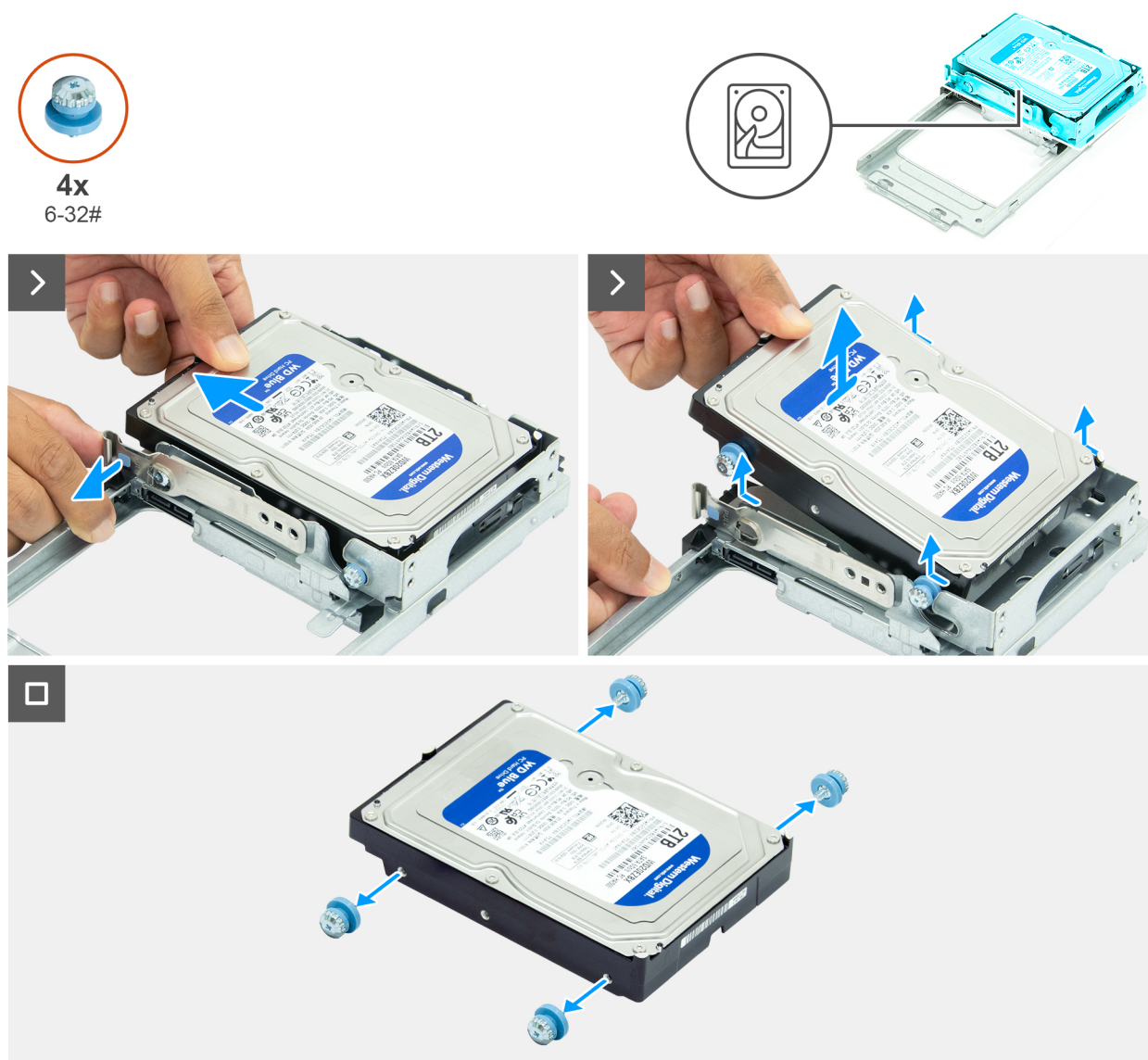
Obrázek 29. Demontáž pevného disku
