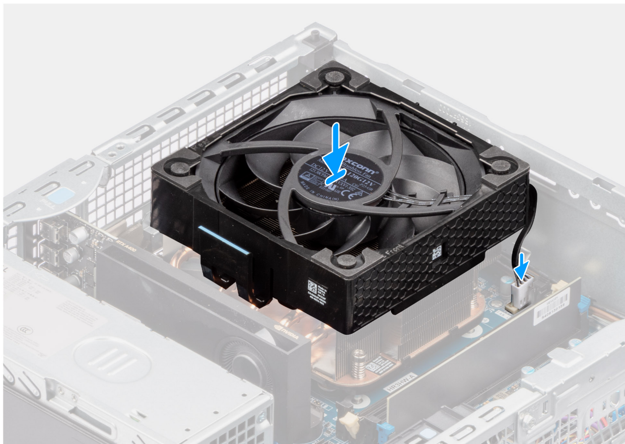
Obrázek 52. Montáž ventilátoru procesoru
