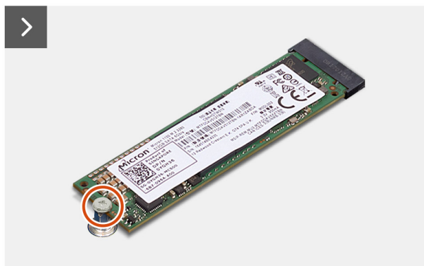
Obrázek 37. Demontáž disku SSD M.2 2280
