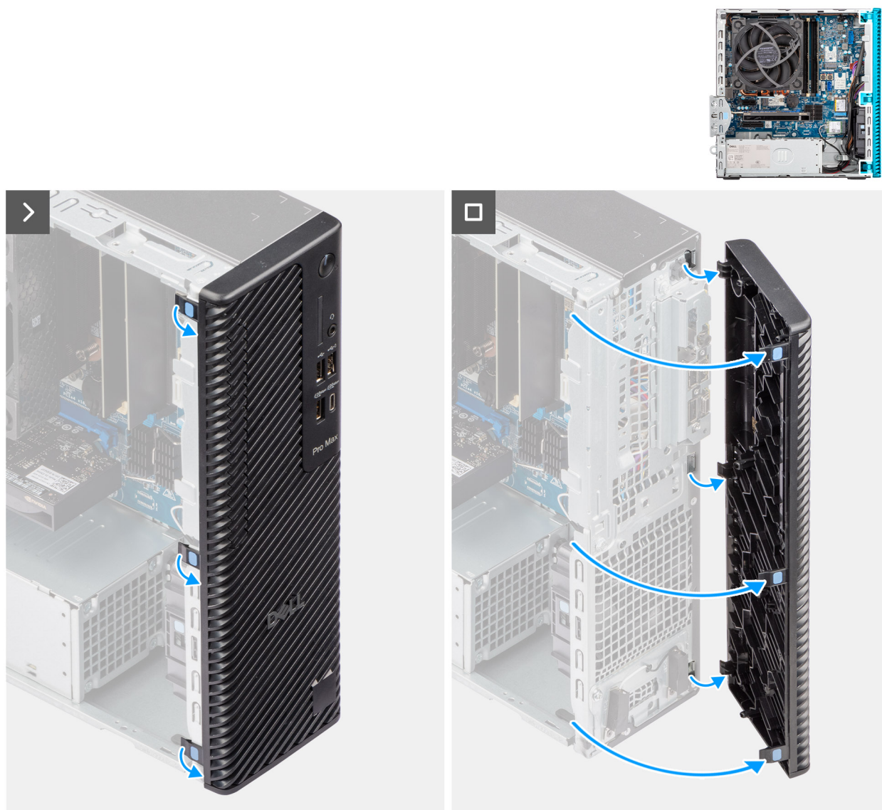
Obrázek 15. Demontáž čelního krytu
