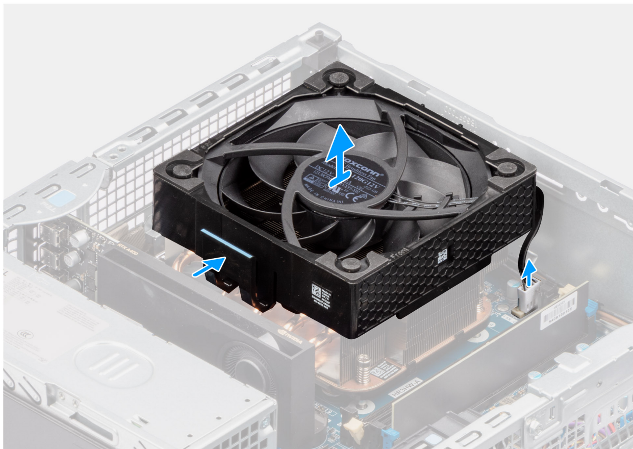
Obrázek 51. Demontáž ventilátoru procesoru
