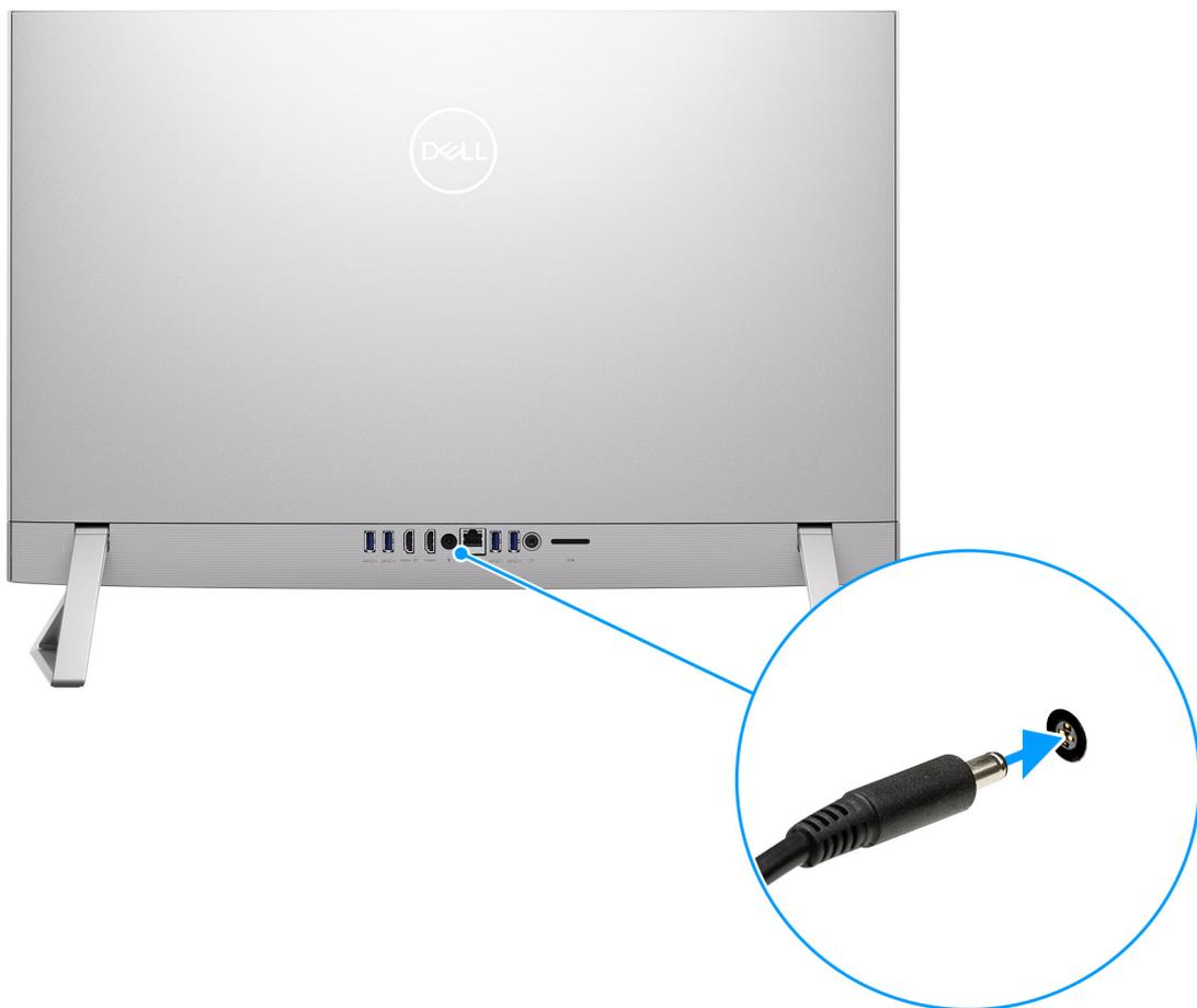
**Figura 12. Collegare l'adattatore per l'alimentazione.**
