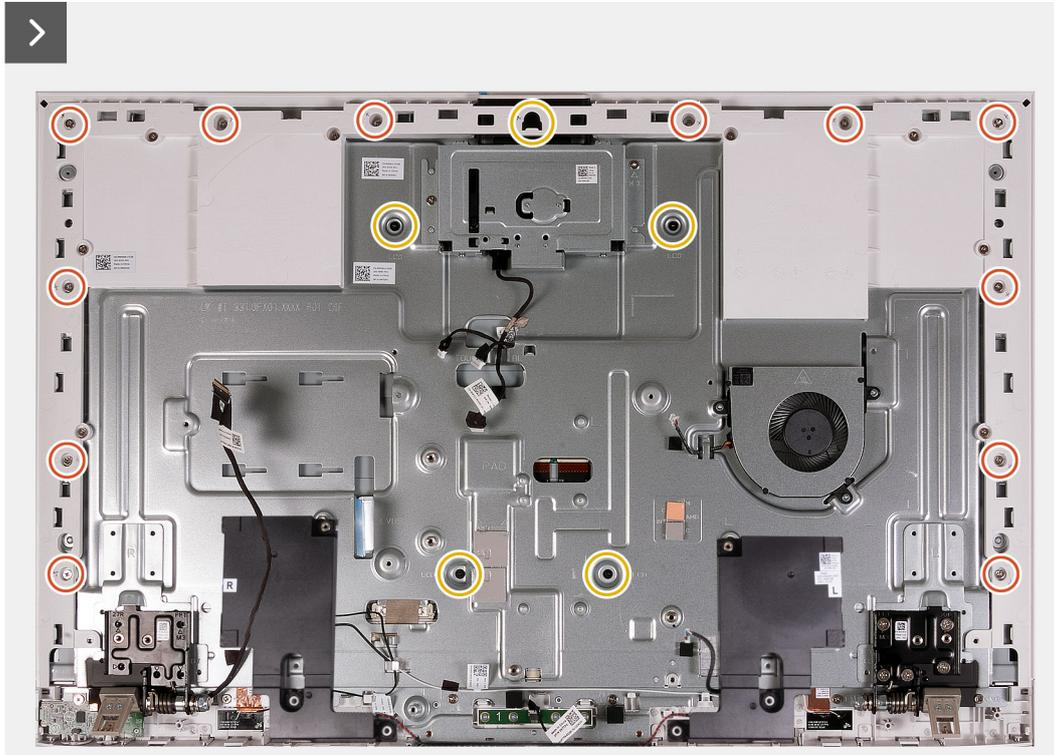
Figura 60. Rimozione delle viti
