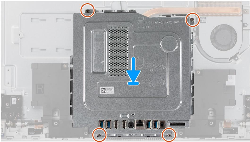
**Figura 27. Installazione della protezione della scheda di sistema**
