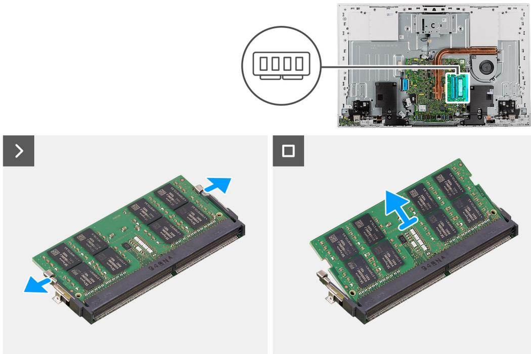
Figura 30. Rimozione del modulo di memoria
