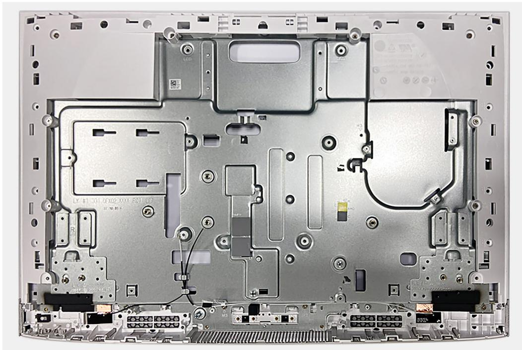
**Figura 64. Rimozione del gruppo dell'intelaiatura centrale**
