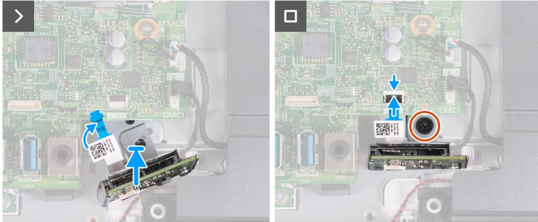
Figura 47. Installazione del lettore di schede multimediali
