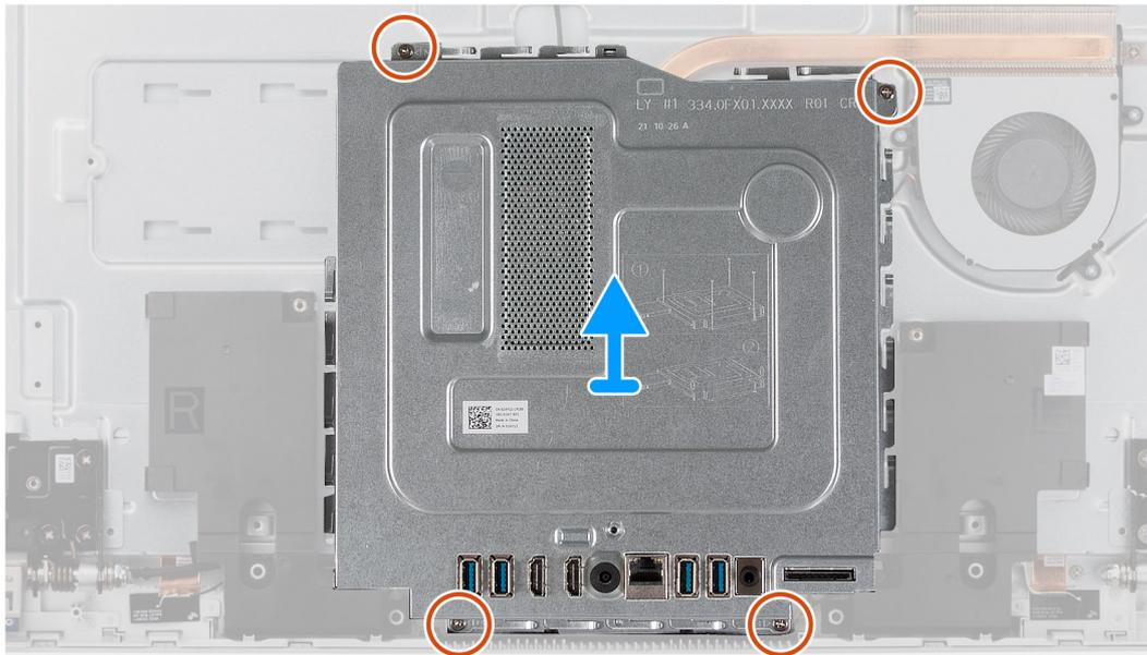
**Figura 26. Rimozione della protezione della scheda di sistema**
