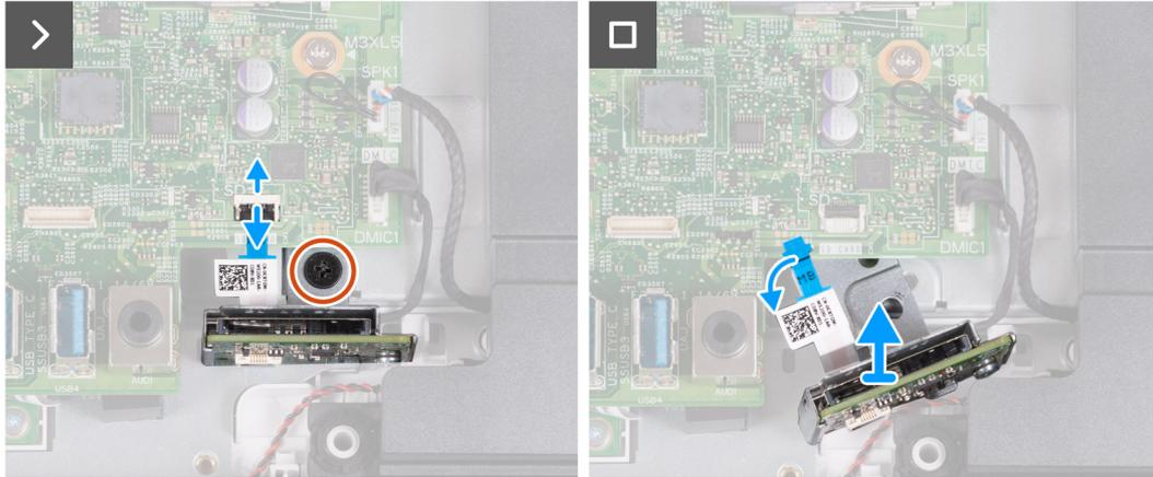
Figura 46. Rimozione del lettore di schede multimediali
