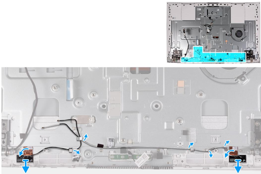
**Figura 58. Rimozione delle antenne**
