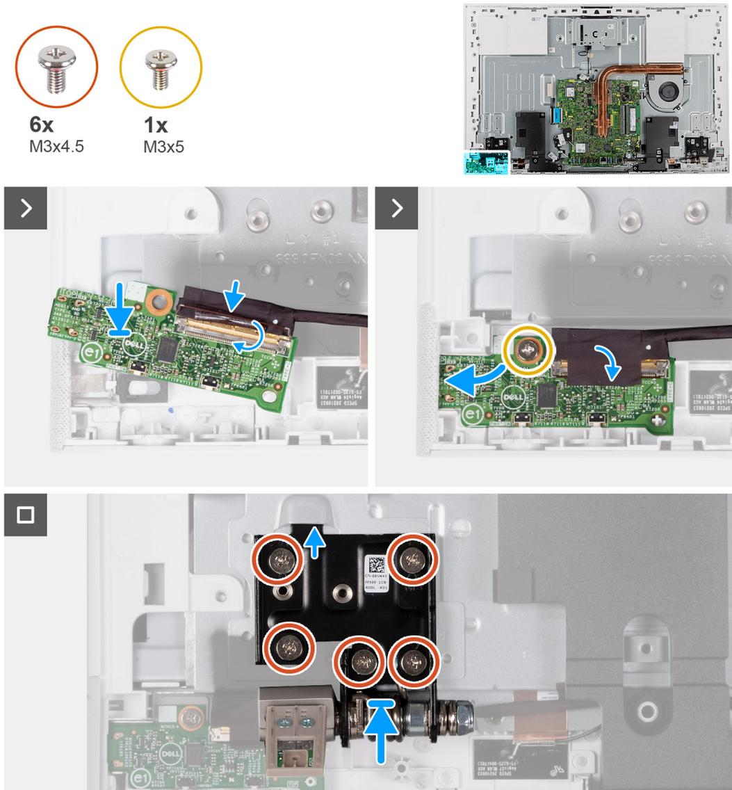
**Figura 49. Installazione della scheda del pulsante di alimentazione con USB**
