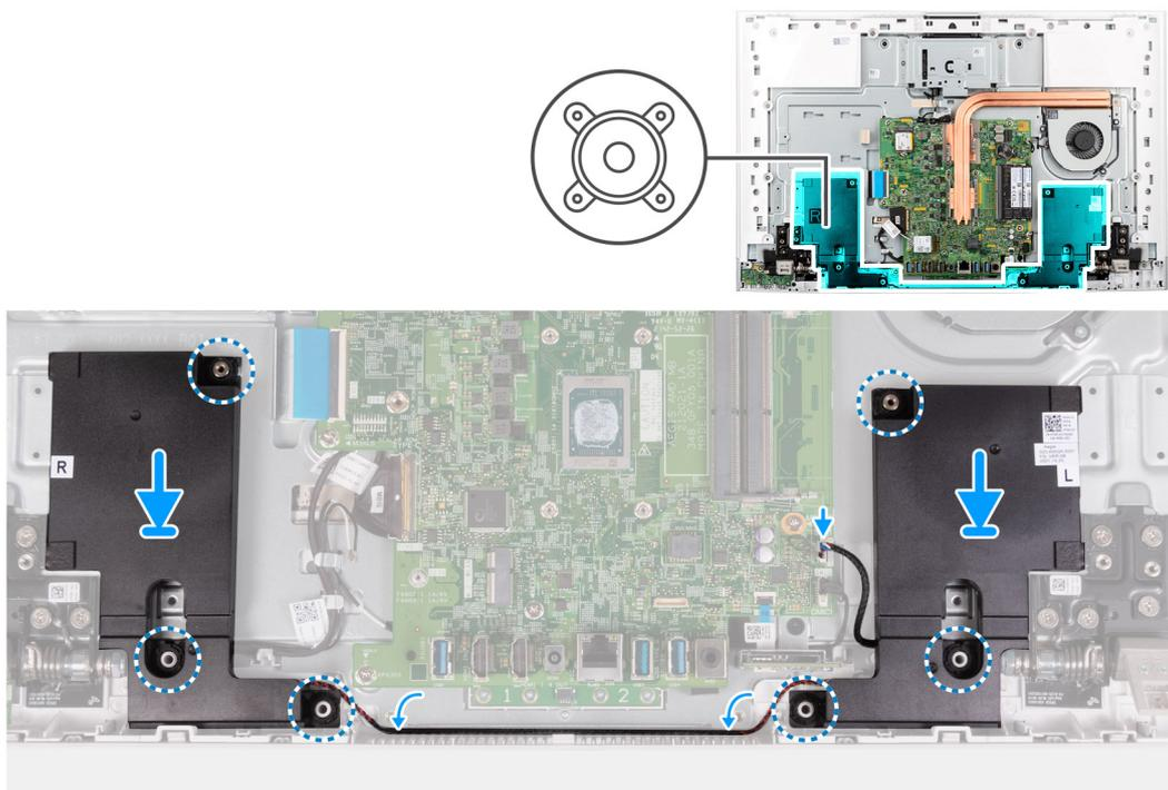
**Figura 39. Installazione degli altoparlanti**
