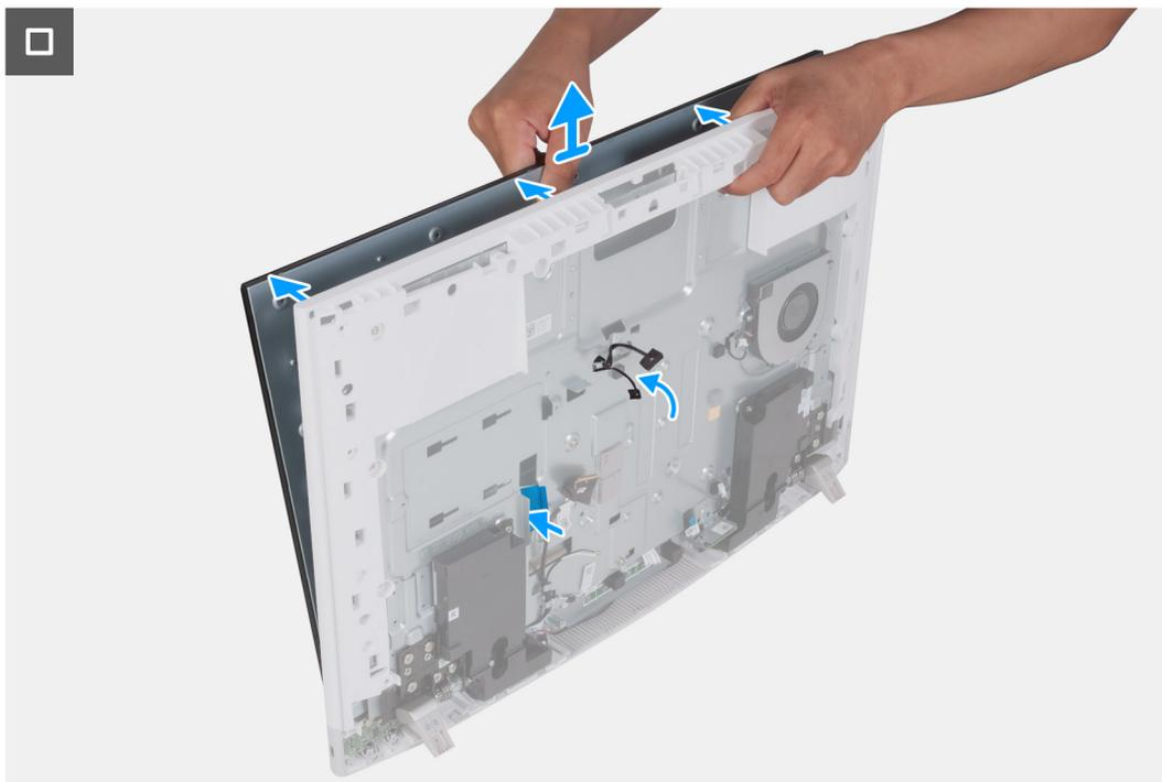
Figura 61. Rimozione del pannello del display
