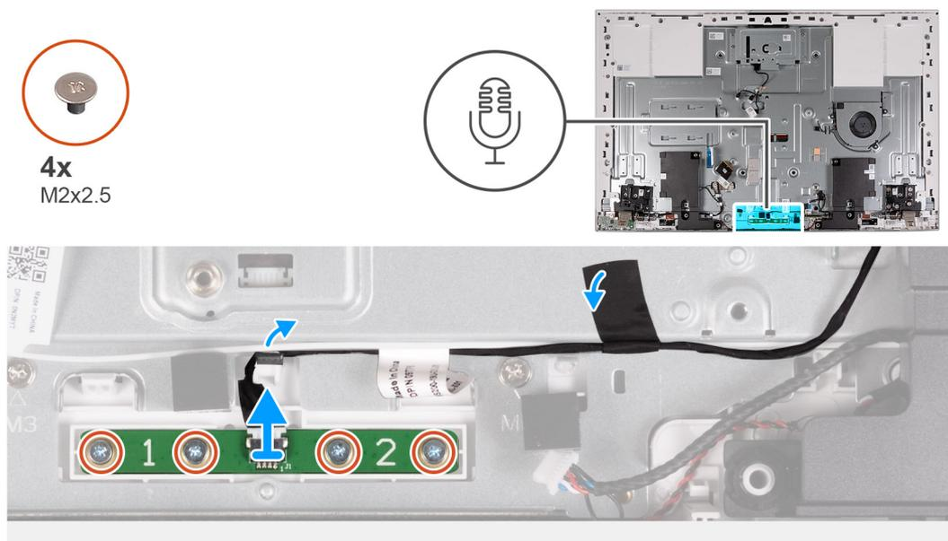
**Figura 56. Rimozione del modulo del microfono**
