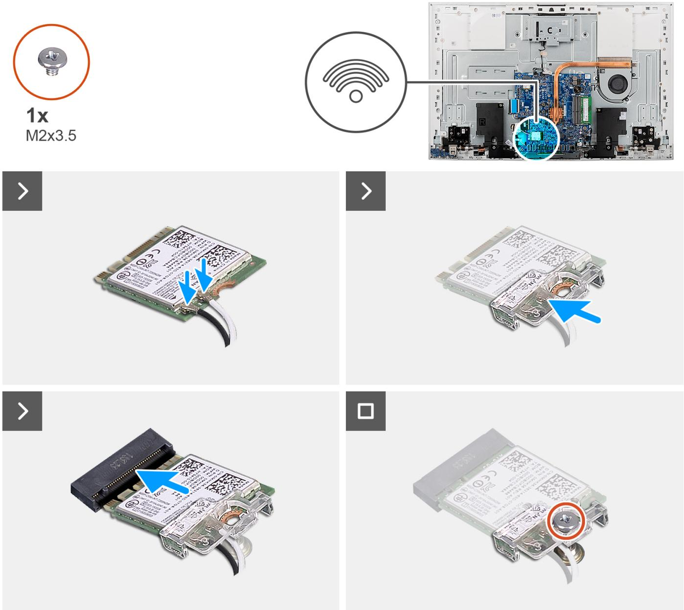
**Figura 33. Installazione della scheda wireless**
