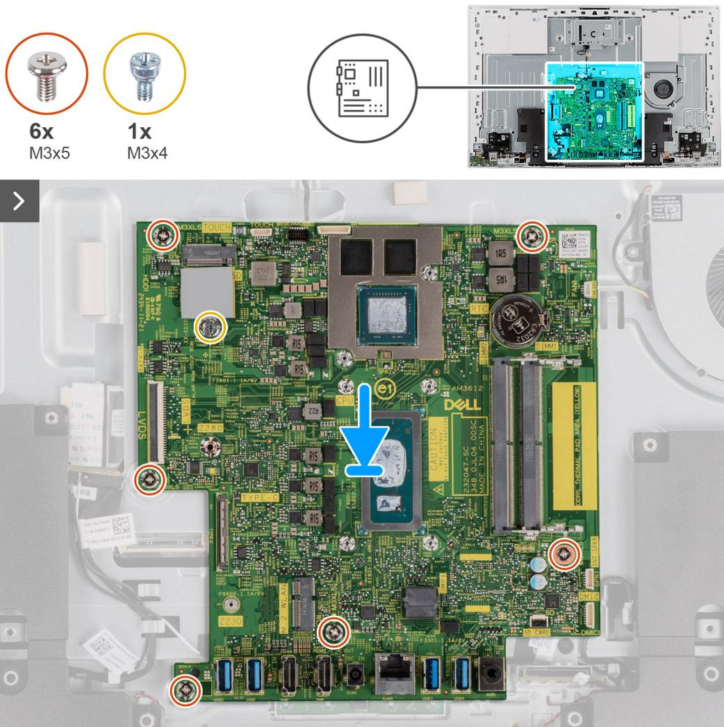
Figura 54. Posizionamento della scheda di sistema nello chassis
