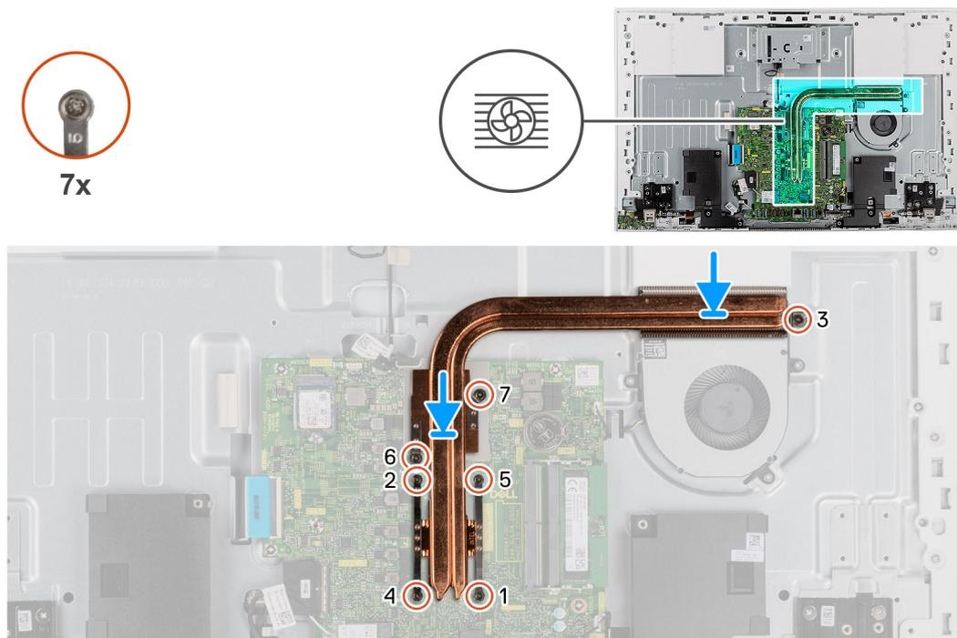
**Figura 45. Installazione del dissipatore di calore (dedicato)**
