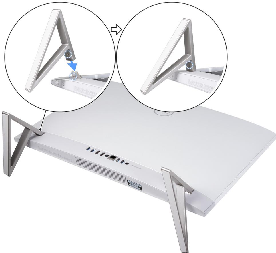
**Figura 9. Installare il supporto**
