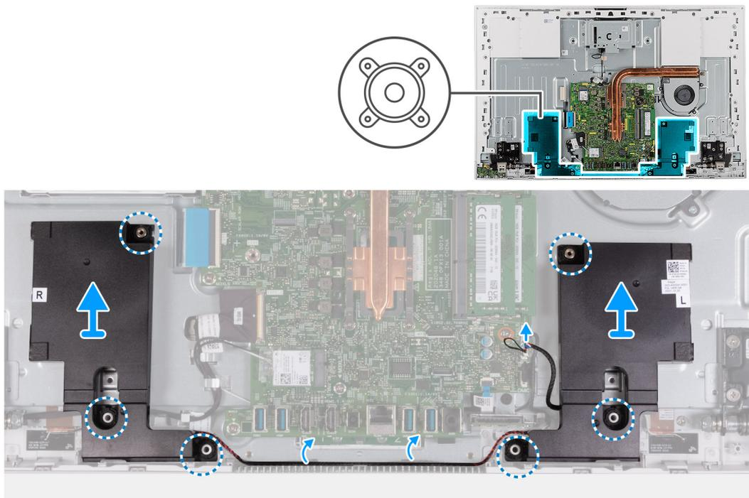
**Figura 38. Rimozione degli altoparlanti**
