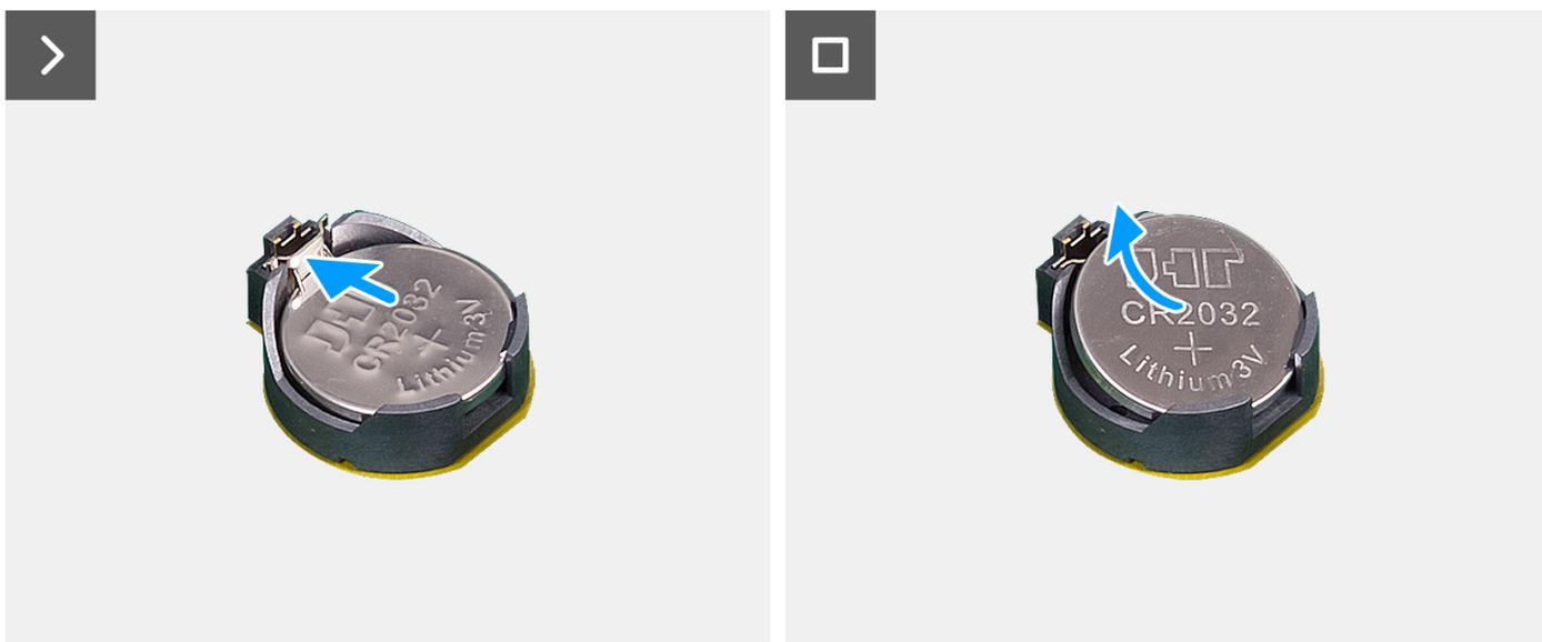
**Figura 40. Rimozione della batteria a bottone**
