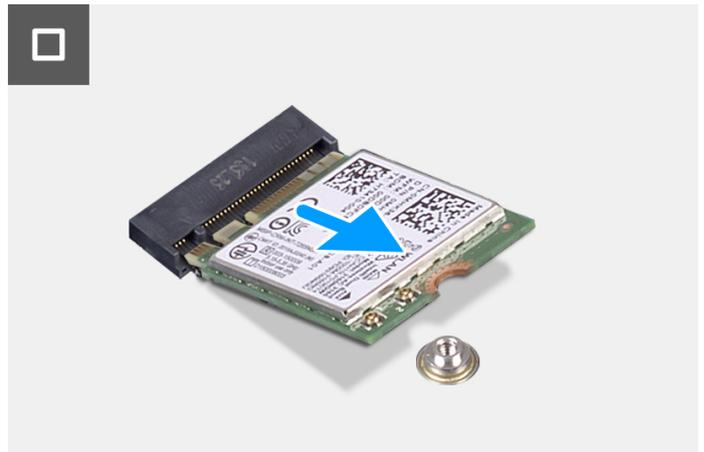
Figura 32. Rimozione della scheda wireless
