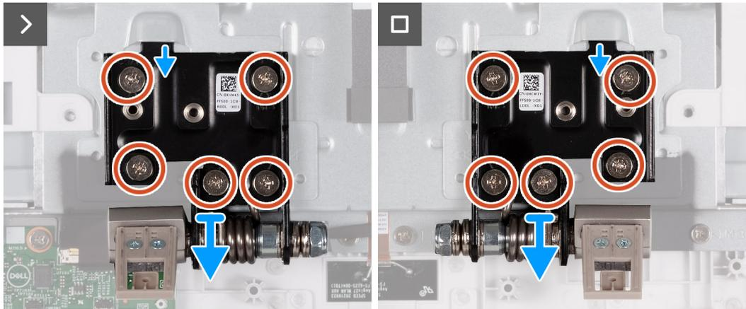
**Figura 24. Rimozione delle cerniere del supporto**
