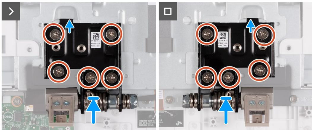
Figura 25. Installazione delle cerniere del supporto
