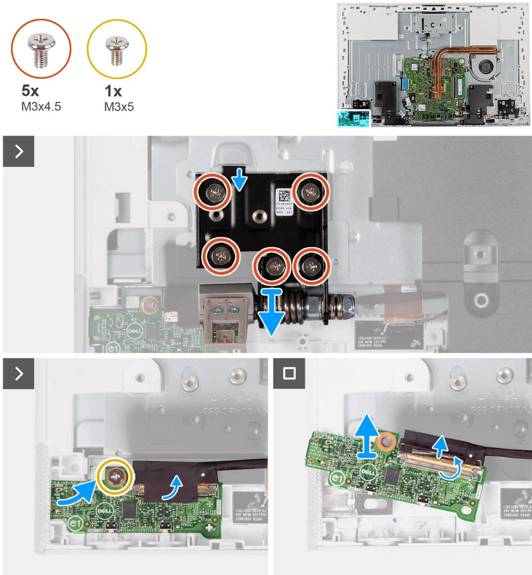
**Figura 48. Rimozione della scheda del pulsante di alimentazione con USB**
