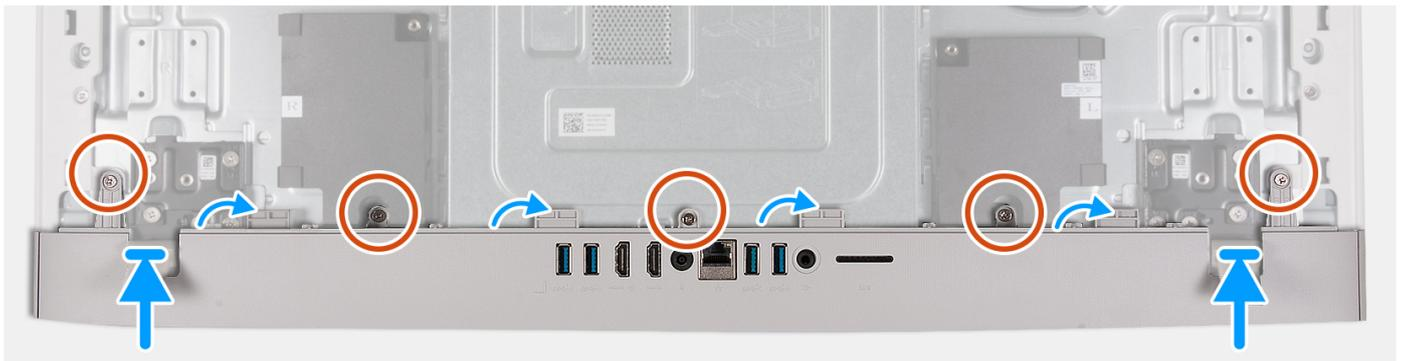
Figura 23. Installazione del coperchio inferiore
