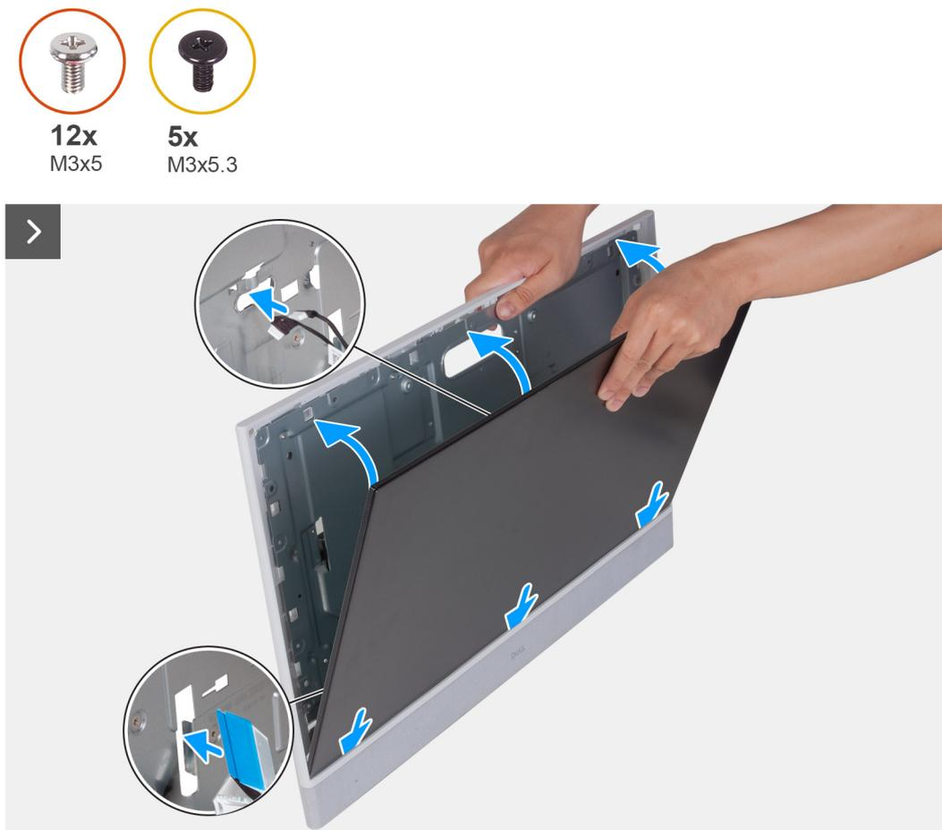
Figura 62. Installazione del pannello del display
