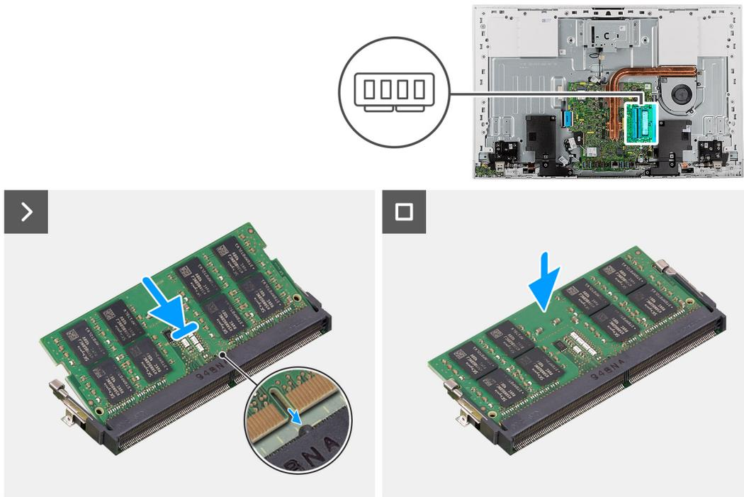
**Figura 31. Installazione del modulo di memoria**
