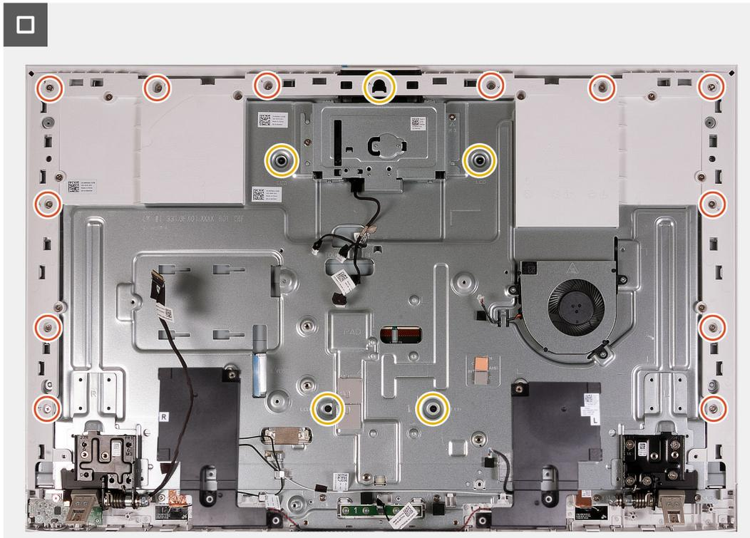
**Figura 63. Ricollocamento delle viti**
