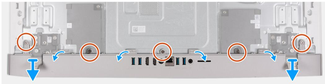
**Figura 22. Rimozione del coperchio di I/O**
