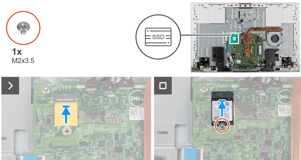
Figura 29. Installazione dell'unità SSD M.2 2230
