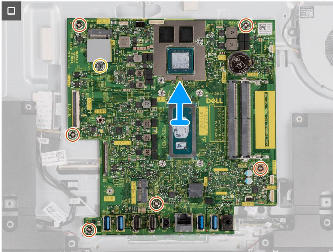
**Figura 52. Estrazione della scheda di sistema dallo chassis**
