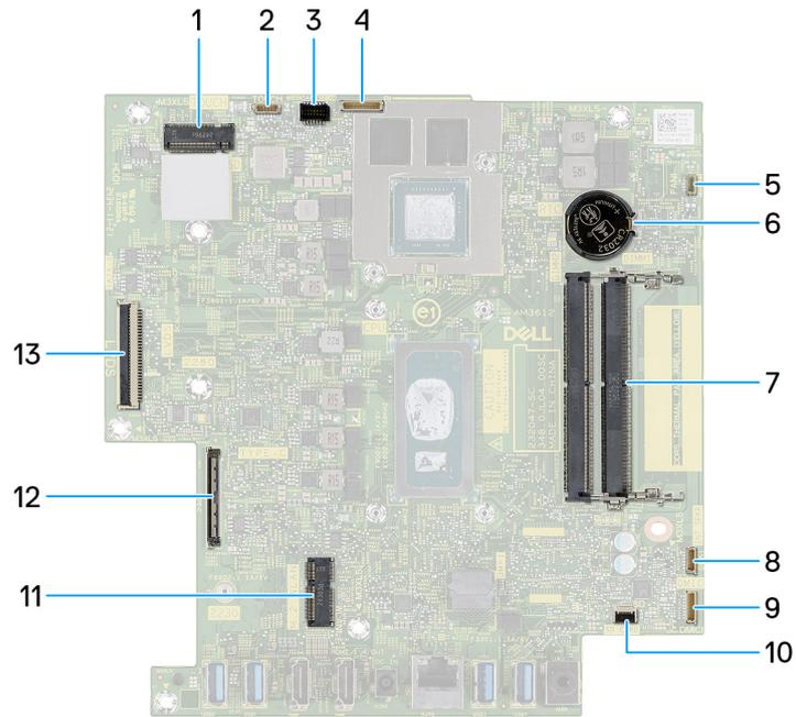
**Figura 50. Connettori della scheda di sistema**
