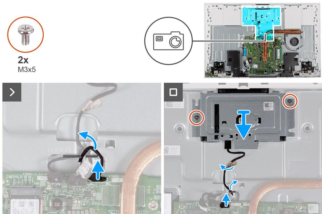
**Figura 34. Rimozione della fotocamera**
