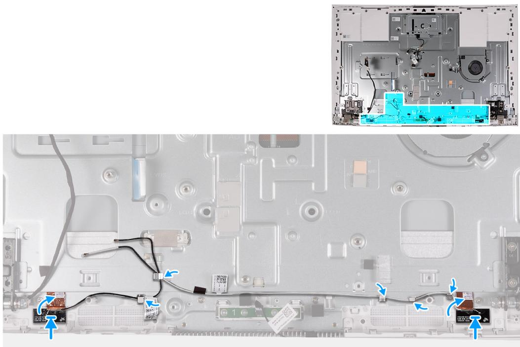
**Figura 59. Installazione delle antenne**
