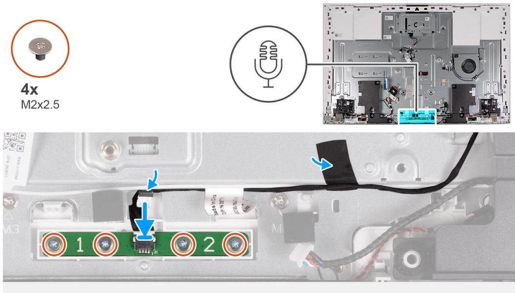
**Figura 57. Installazione del modulo del microfono**
