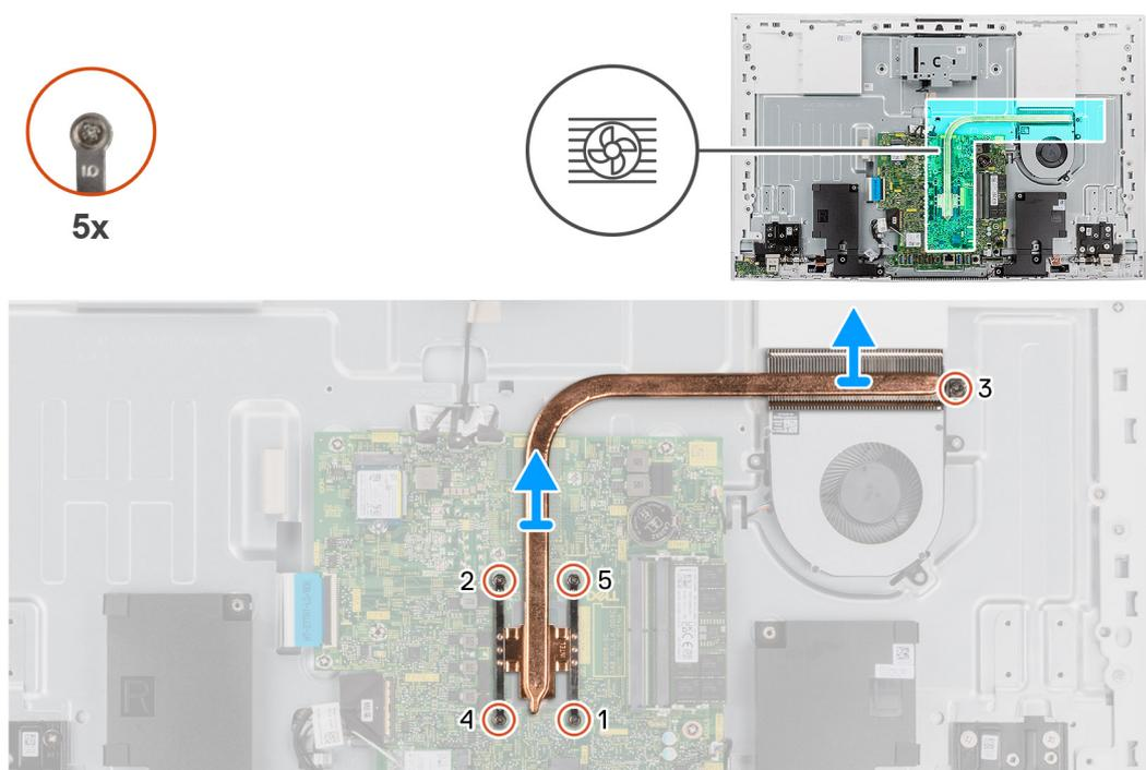
**Figura 42. Rimozione del dissipatore di calore (UMA)**
