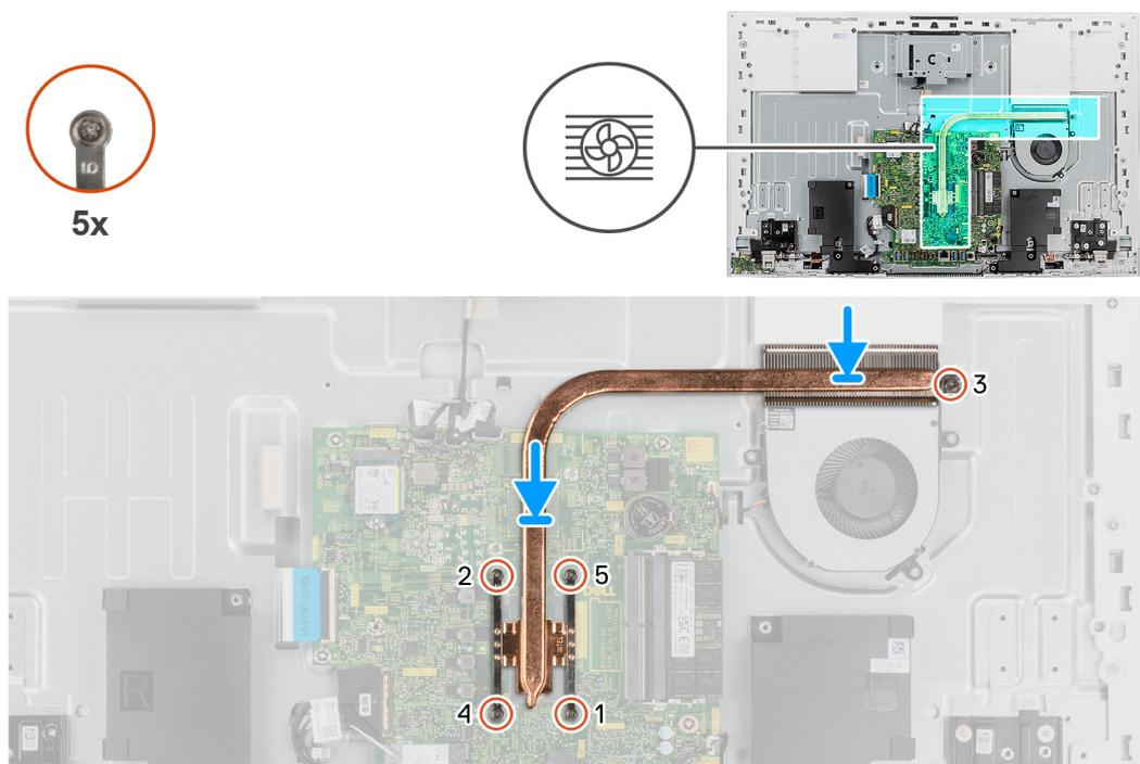
**Figura 43. Installazione del dissipatore di calore (UMA)**
