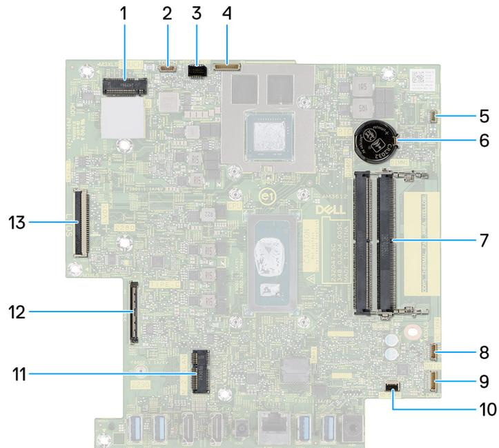
**Figura 53. Connettori della scheda di sistema**
